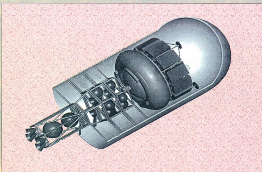
Теплозащитные «санки» с комбинированным посадочным модулем
