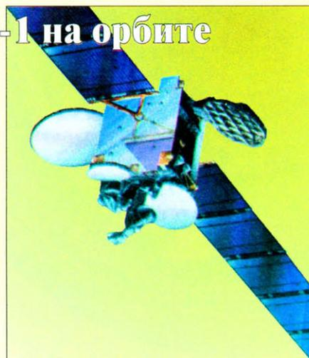
блока Eurostar 2000+. Стартовая масса КА – 3255 кг, масса на орбите – 1753 кг. Аппарат оснащен 14 ретрансляторами диапазона С и 18 ретрансляторами диапазона Ku и имеет мощность СЭП – 8.3 кВт.
