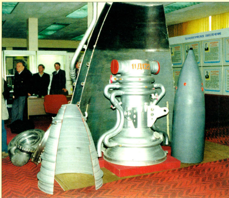
Оболочки камеры и сопла двигателя 11Д122 (РД-0120) дают представления о его размерах и сложности работы
