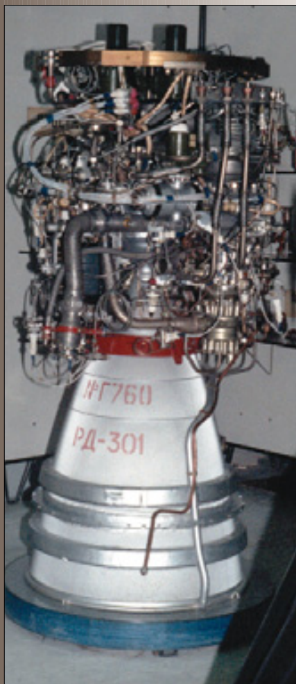
Фторо-аммиачный двигатель РД-301, прошедший полный объем стендовых испытаний.
