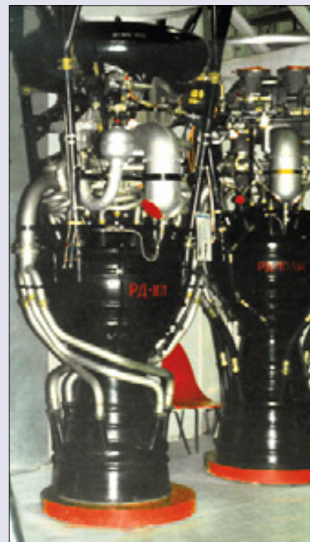
Первые мощные кислородно-спиртовые ЖРД разработки ОКБ-456: РД-101 для ракеты Р-2 и РД-103 для Р-5М.
