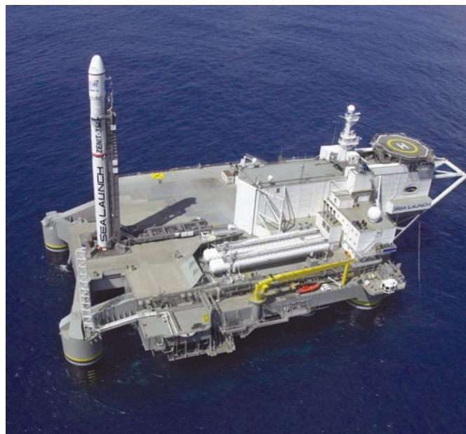
РКН «Зенит-3SL», установленная на пусковом столе СП «Одиссей» в точке старта на экваторе
