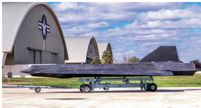
Беспилотный разведчик Локхид D-21, принятый на вооружение ВВС США в 1969 г. — очень скоростной и высотный, но с несовершенной системой управления.
