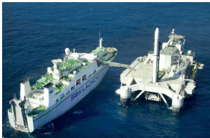
Рис. 6. Ракетно-космический комплекс «Морской старт»: слева — сборочно-командное судно (СКС); справа — плавучая платформа «Одиссей»
