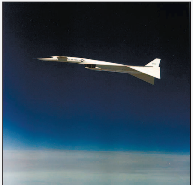
В крейсерском полете законцовки крыла XB-70 опускались — «Валькирия» стала первым в мире тяжелым самолетом с изменяемой геометрией крыла Фото: //planeaday.com
