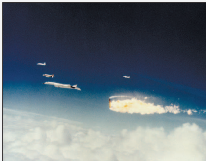
После столкновения с NF-104 лишившийся килей XB-70 AV-2 сохранял горизонтальный полет, пока не начало разрушаться крыло. Фото: //area51specialprojects.com/nasa/xb70midair.html
