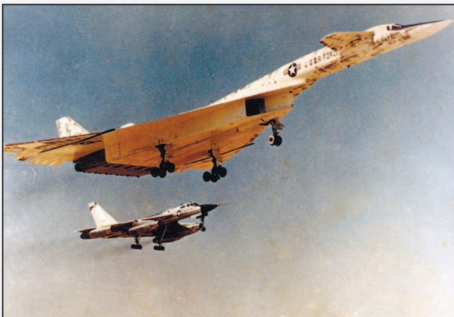
Посадка ХВ-70 №1 после выхода на число M=3 в сопровождении В-58А. «Валькирия» стала самым большим в мире сверхзвуковым самолетом того времени Фото: North American — Rockwell Corporation
