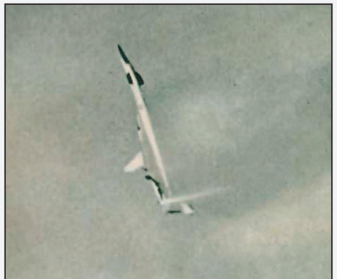
Крыло XB-70 начинает разрушаться — и он переходит в штопор. Фото: //area51specialprojects.com/nasa/xb70midair.html
