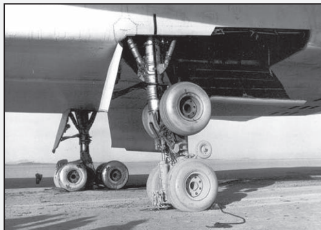
Поломка основной стойки шасси ХВ-70 на посадке 3 июля 1966 г. не привела к тяжелым последствиям Фото: North American — Rockwell Corporation
