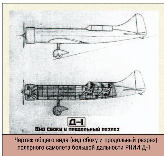
Чертеж общего вида (вид сбоку и продольный разрез) полярного самолета большой дальности РНИИ Д-1
