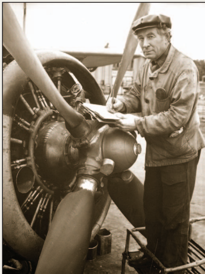
Работа конструкторов ФЭДа по улучшению агрегатов топливопитания массовых авиадвигателей АШ 62ИР (на фото), АИ 14 и АИ-20 имела важнейшее народно-хозяйственное значение. Фото: архив Е.З. Буцкого
