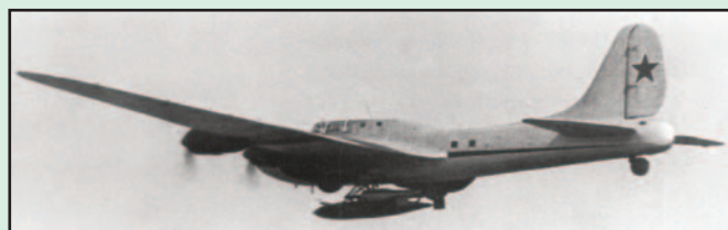
Носитель Пе-8 уходит на испытательный пуск самолета-снаряда 16ХА «Прибой». Фото: //airforce.ru
