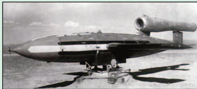
Самолет-снаряд 10Х на девиационном круге — идет настройка магнитного корректора перед испытательным пуском Фото: //testpilot.ru
