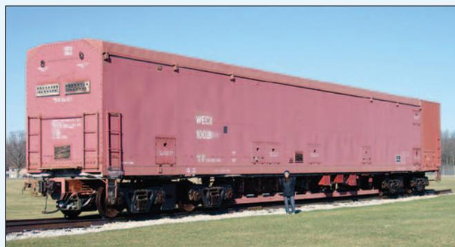
Межконтинентальная баллистическая ракета LGM-118A «Реасекеерег» железнодорожного базирования. Этот проект доработан не был, единственный испытательный пуск ракеты из железнодорожной пусковой установки по техническим причинам не состоялся и был заменен бросковым испытанием. Человек на фото дает возможность представить размеры комплекса
