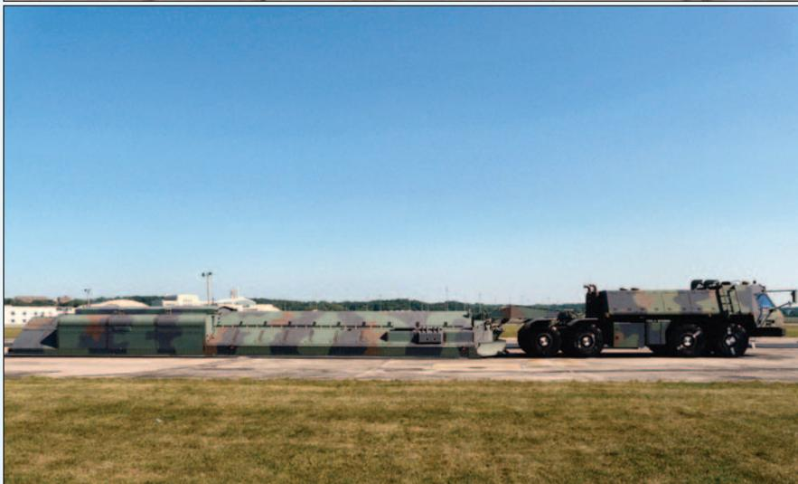
Опытный прототип защищенного мобильного стартового комплекса корпорации «Boeing» для запуска МБР MGM-134 «Миджитмен»
