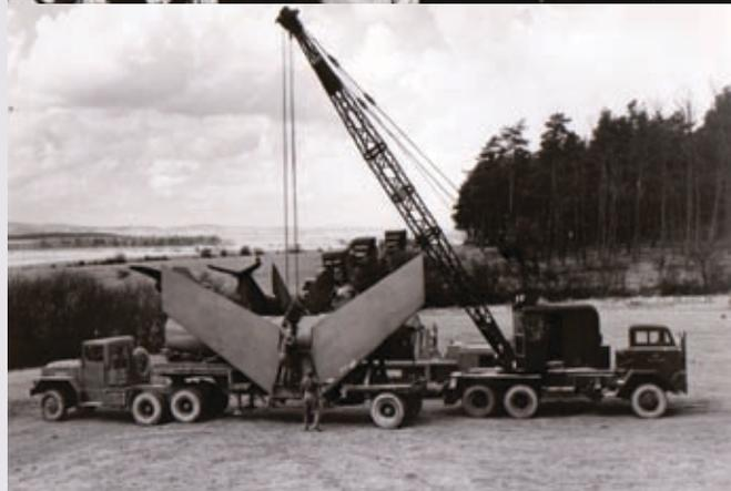
Сборка B-61A Matador непосредственно на пусковой установке
