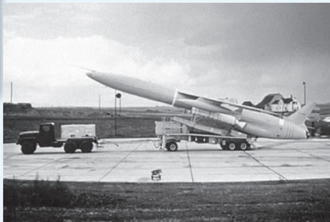
Транспортировка мобильной пусковой установки ракеты SM-62 Snark к месту пуска
