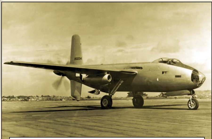
Переоборудованный в летающую лабораторию первый опытный самолет XB-42A с турбореактивными двигателями под крылом. Фото: http://upload.wikimedia.org
