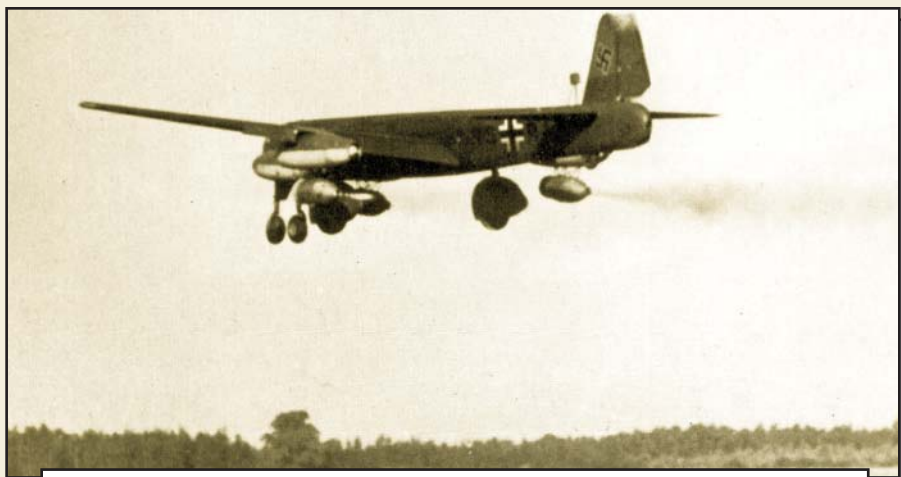
Самолет Ju 287V1 взлетает с включенными стартовыми ускорителями. Хорошо видны отклоненные закрылки. Фото: Wagner W. Die Erste Strahlflugzeuge der Welt
