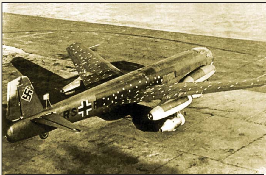
Для визуализации обтекания крыла и средней части фюзеляжа обшивка Ju 287V1 была оклеена пряжами шерстяных волокон. Их поведение снимала кинокамера на стойке перед килем. Фото: http://www.warbirdsresourcegroup.org/LRG/images/ju287-7.jpg
