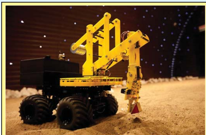
Прототип «марсианского» ровера для имитации дистанционной деятельности на поверхности планеты
