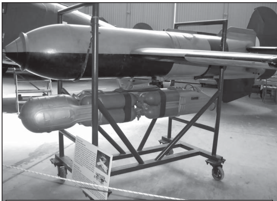
Хеншель Hs 293A-1 — противокорабельная ракета или планирующая бомба. На фото экземпляр, испытывавшийся после войны в Чехословакии. Фото С.Г. Мороза
