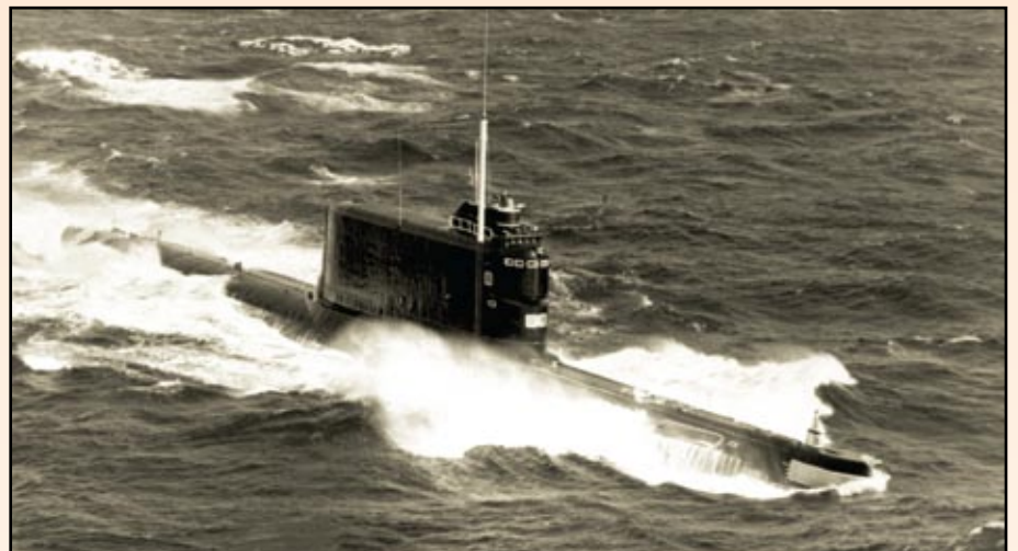
Подводная лодка проекта 629 — советская дизель-электрическая подводная лодка с баллистическими ракетами. Впервые в СССР лодки этого типа изначально проектировались для оснащения баллистическими ракетами. Каждая субмарина несла три ракеты типа Р-13
