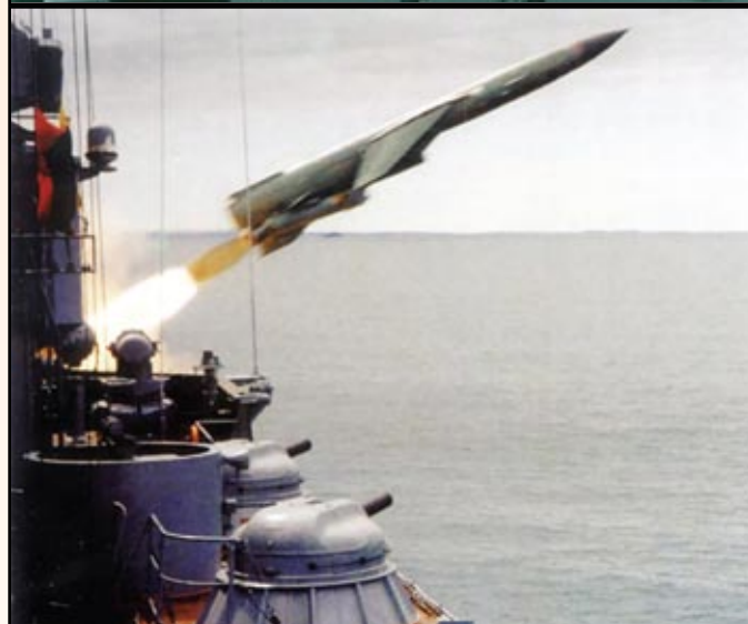
П-35 (П-6) — советская крылатая противокорабельная ракета. Предназначалась для вооружения надводных кораблей, подводных лодок и береговых ракетных комплексов
