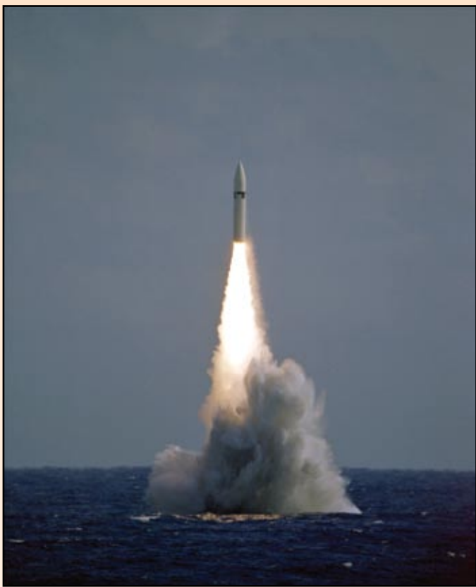
Пуск UGM-27C Polaris A-3 с атомного подводного ракетоносца USS Robert E. Lee (SSBN-601), 1978 г. UGM-27 «Polaris» — двухступенчатая твердотопливная баллистическая ракета, предназначенная для размещения на атомных подводных лодках
