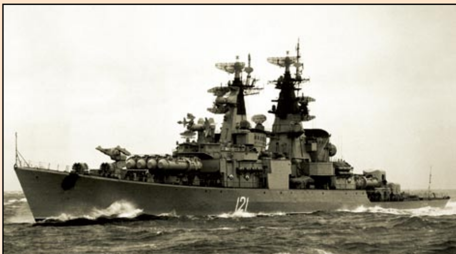
Ракетный крейсер «Грозный» проекта 58. Крейсера этого проекта — первые советские ракетные крейсера с противокорабельным ракетным вооружением
