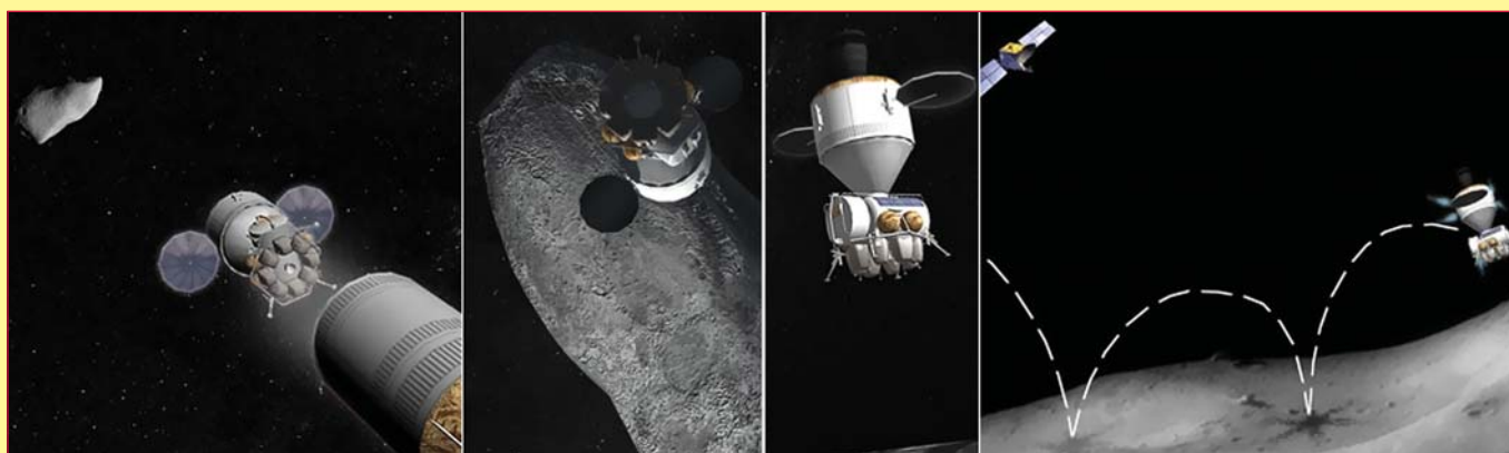
Перед путешествием к астероиду корабль Orion стыкуется с EDS на околоземной орбите, после чего EDS включает двигатель и вся связка отправляется в путешествие к намеченному астероиду. Во время перелета NSAM служит дополнительной жилплощадью для экипажа. Иллюстрация DigitalSpace Commons
