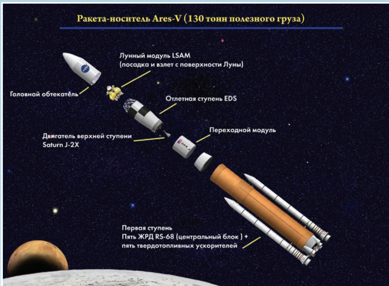
Схема ракеты-носителя Ares-V
