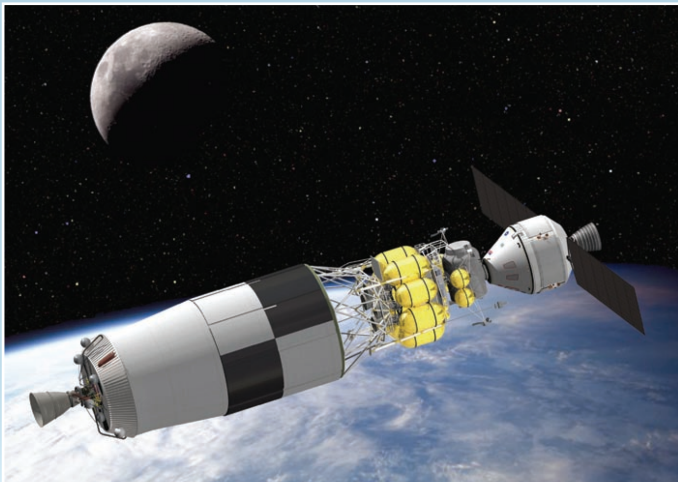
Отлетная ступень (EDS) Ares-V, состыкованная с модулем Orion (концепция)
