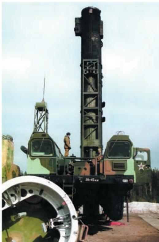
*Пусковая установка комплекса "Тополь" после запуска ракеты. На переднем плане крышка транспортно-пускового контейнера*
