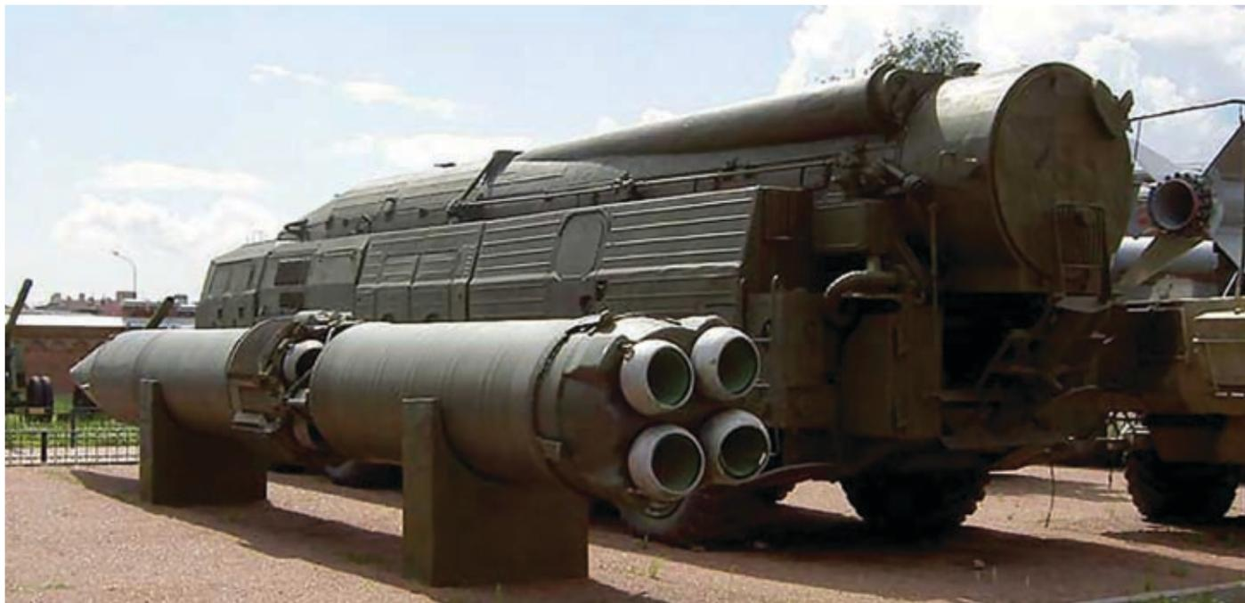
*Ракета 9М76 комплекса "Темп-С". Рядом пусковая мобильная установка*
