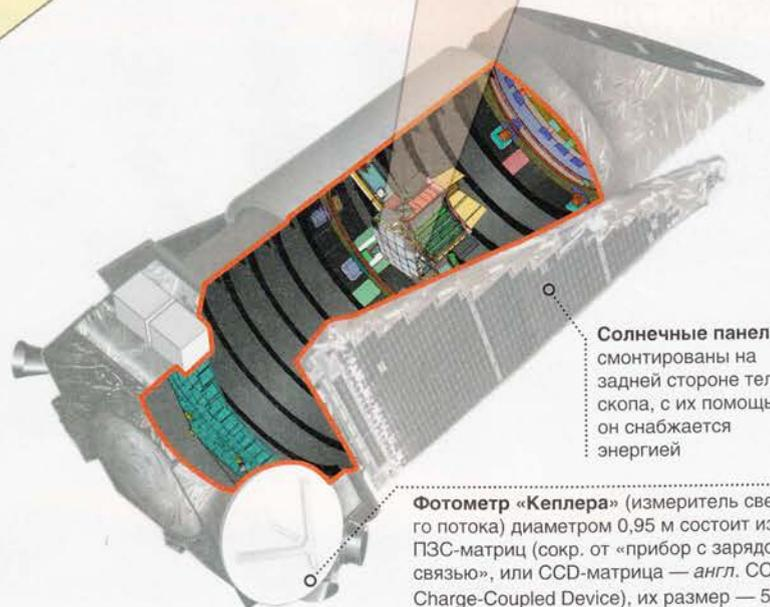
**Солнечные панели** смонтированы на задней стороне телескопа, с их помощью он снабжается энергией
