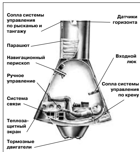
Космический корабль «Меркурий» представлял собой довольно тесную баллистическую капсулу.
