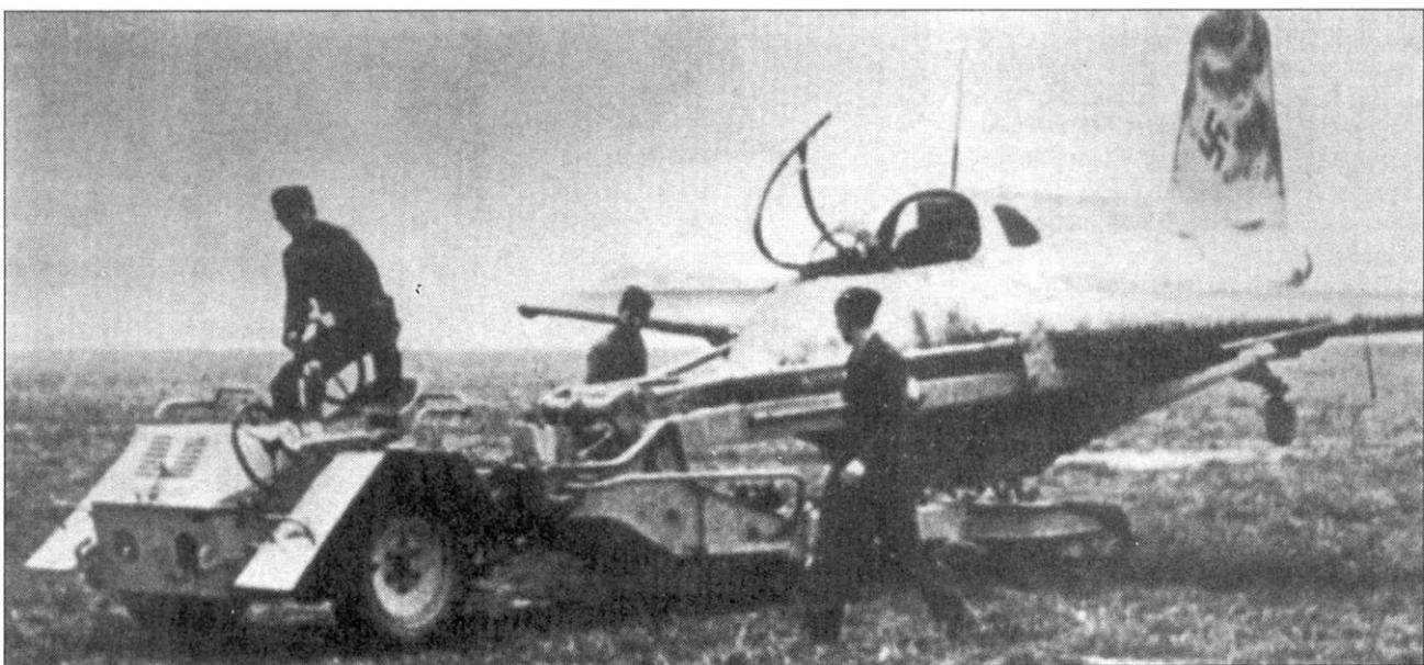
Тягач Scheuschlepper, предназначенный для буксировки «Комет».
