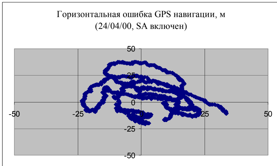
Рис.7.10. Ошибка определения положения в плоскости при помощи системы GPS, SA включен.
