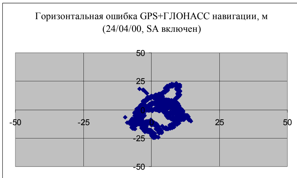
Рис. 7.11. Ошибка определения положения в плоскости при помощи системы GPS+ГЛОНАСС, SA включен.
