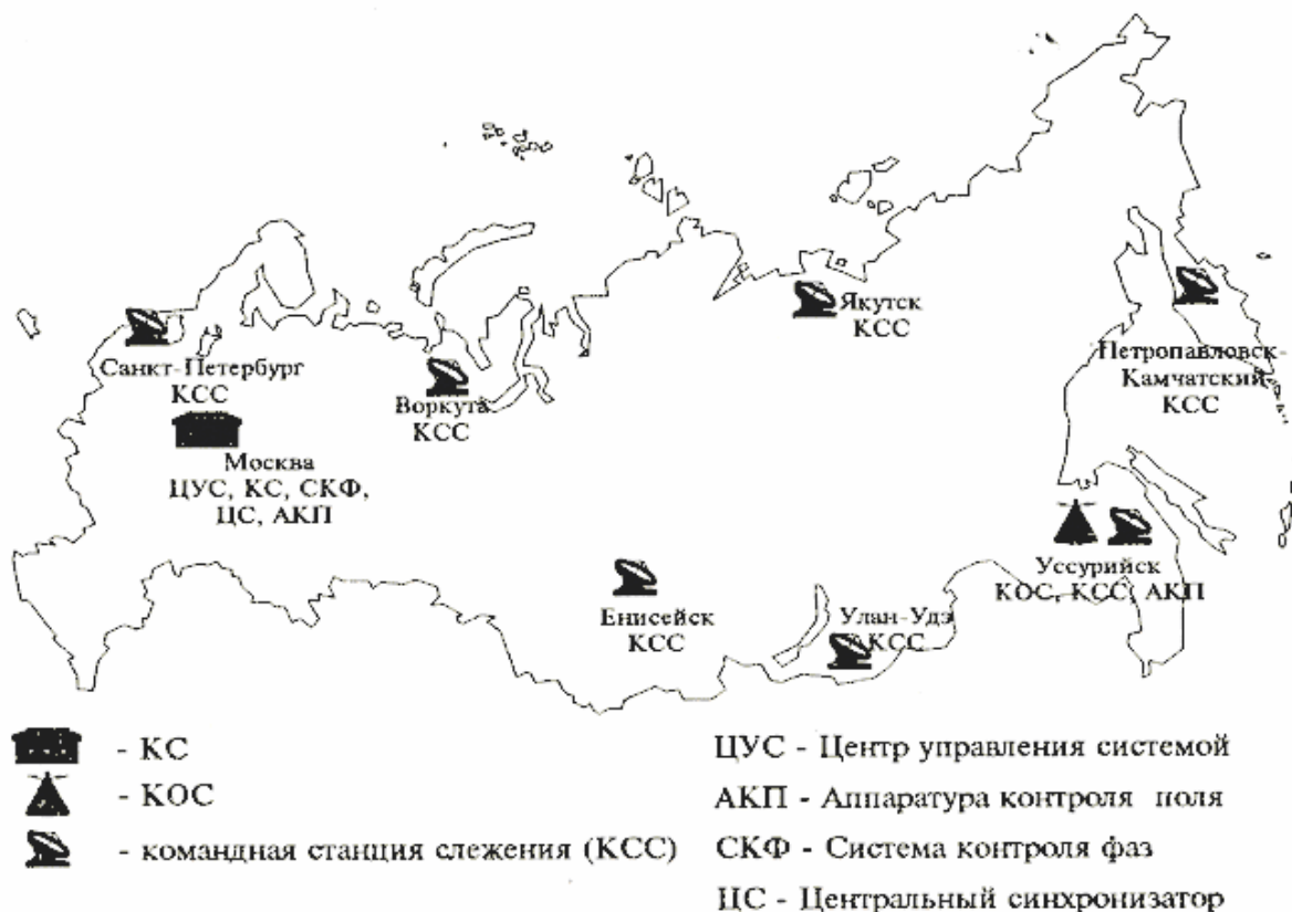
Рис. 6.2. Наземный сегмент системы ГЛОНАСС.
