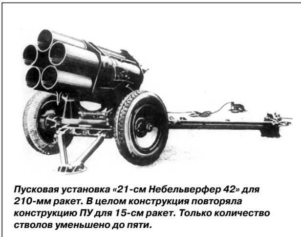
**Пусковая установка «21-см Nebelwerfer 42» для 210-мм ракет. В целом конструкция повторяла конструкцию ПУ для 15-см ракет. Только количество стволов уменьшено до пяти.**
