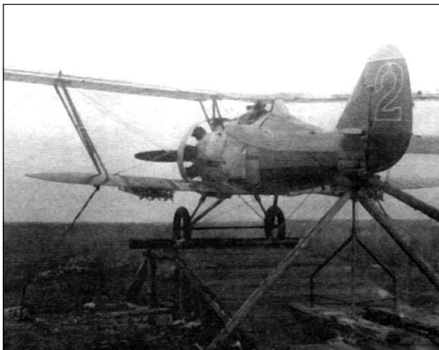
Наземные испытания реактивных снарядов РС-82 с истребителя И-5.
