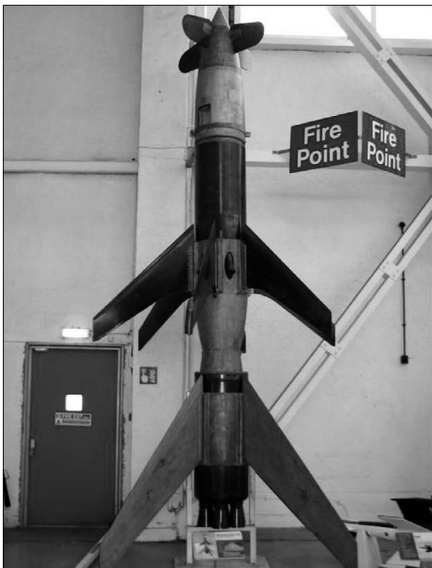
**Музейный «Рейнтохтер R-1».** Хорошо видна общая компоновка ракеты. Дополнительные панели на стабилизаторе отсутствуют.
