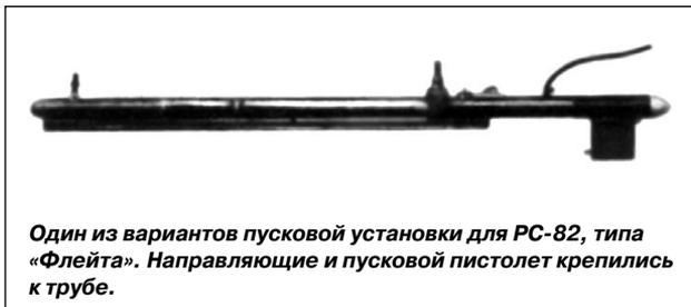
**Один из вариантов пусковой установки для РС-82, типа «Флейта». Направляющие и пусковой пистолет крепились к трубе.**
