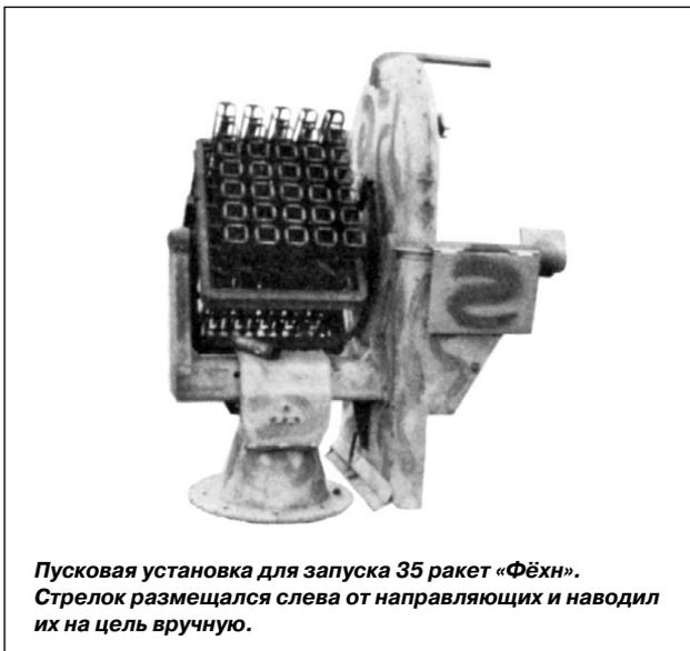
**Пусковая установка для запуска 35 ракет «Фёхн». Стрелок размещался слева от направляющих и наводил их на цель вручную.**
