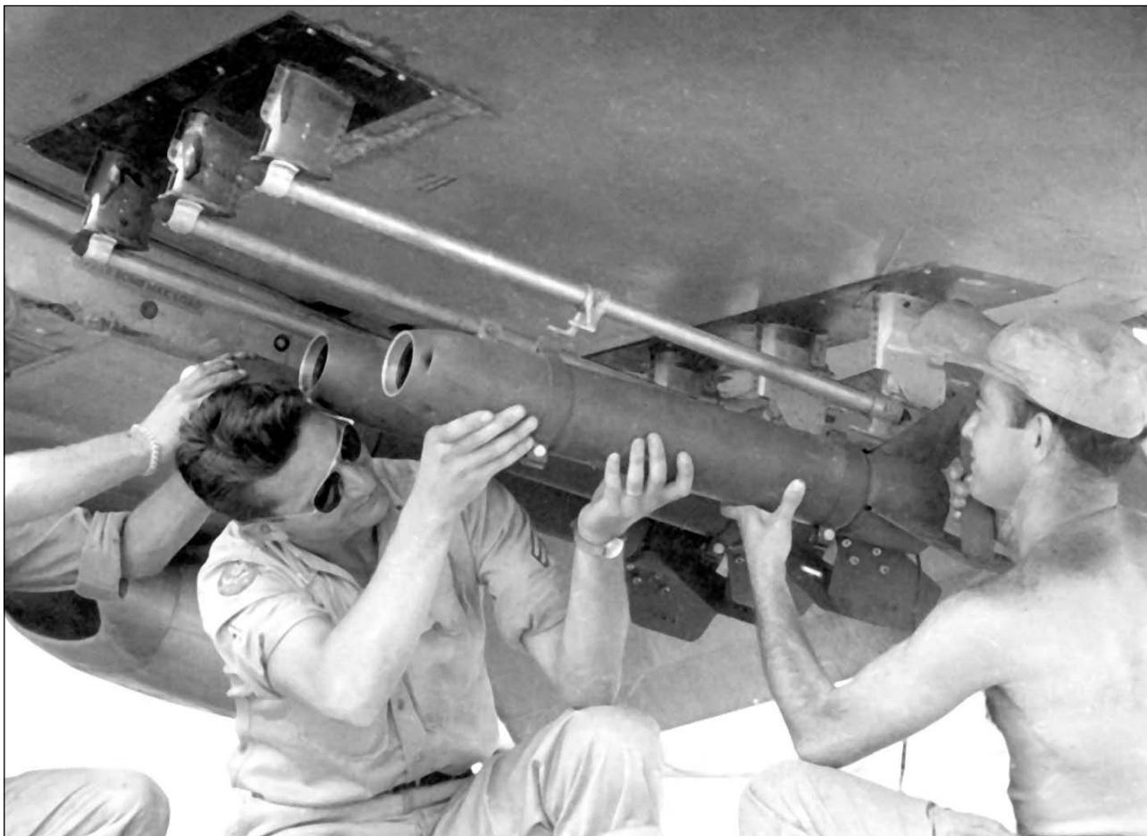
**Реактивный снаряд М-8 с фиксированным хвостовым оперением.**
