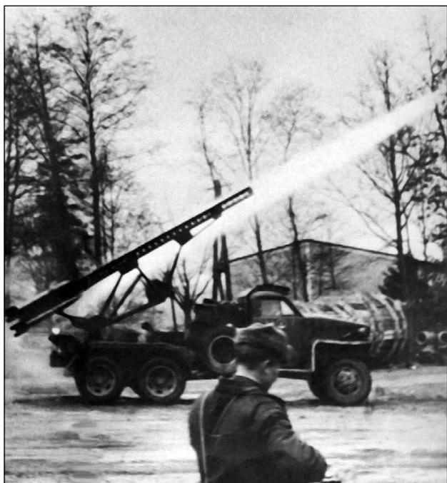
**Боевая машина БМ-13-16Н на базе автомобиля «Студебекер». Вид в профиль. У бойца на переднем плане, по-видимому, выносной пульт для запуска ракет.**
