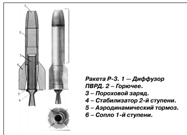
Ракета Р-3. 1 — Диффузор ПВРД. 2 — Горючее. 3 — Пороховой заряд. 4 — Стабилизатор 2-й ступени. 5 — Аэродинамический тормоз. 6 — Сопло 1-й ступени.
