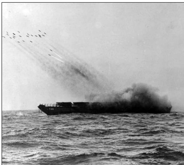
**Залп 5-дюймовых (127 мм) ракет с борта британской десантной баржи. Пусковые установки крепились под углом 45 градусов. После выхода на расчётную дистанцию командир корпусом корабля выполнял наведение по азимуту и производил залп из примерно 1000 ракет в течение 45 сек. Затем баржа подходила к берегу и высаживала морских пехотинцев.**
