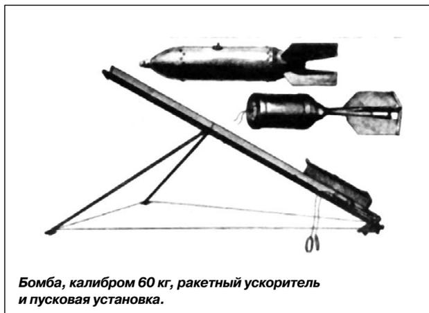
**Бомба, калибром 60 кг, ракетный ускоритель и пусковая установка.**
