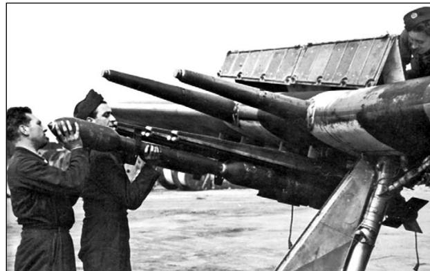
**Пусковые установки истребителя «Тайфун» снаряжаются ракетами RP.**
