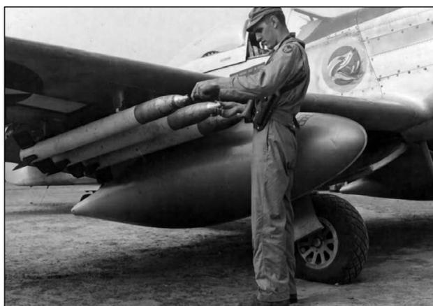
*Ракеты HVAR, кал. 127 мм, на пусковых установках с нулевыми направляющими. Истребитель «P-51D Мустанг».*
