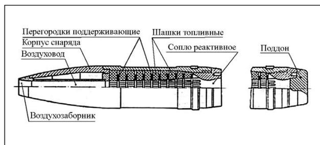
Рис. 1. Ракета с ПВРД на основе 76-мм снаряда.
