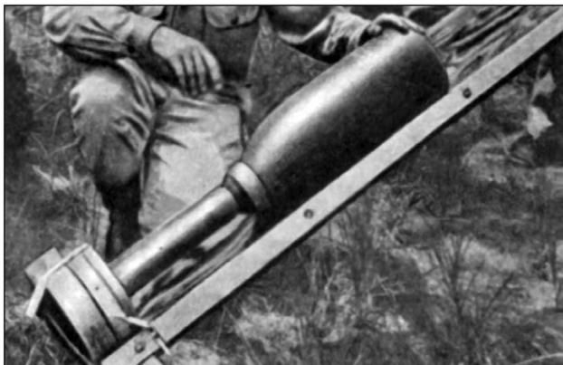
*Мощная ракета Т-37, предназначенная для разрушения bunkеров, имела калибр 183 мм. Для запуска она устанавливалась на простейшем деревянном лотке.*
