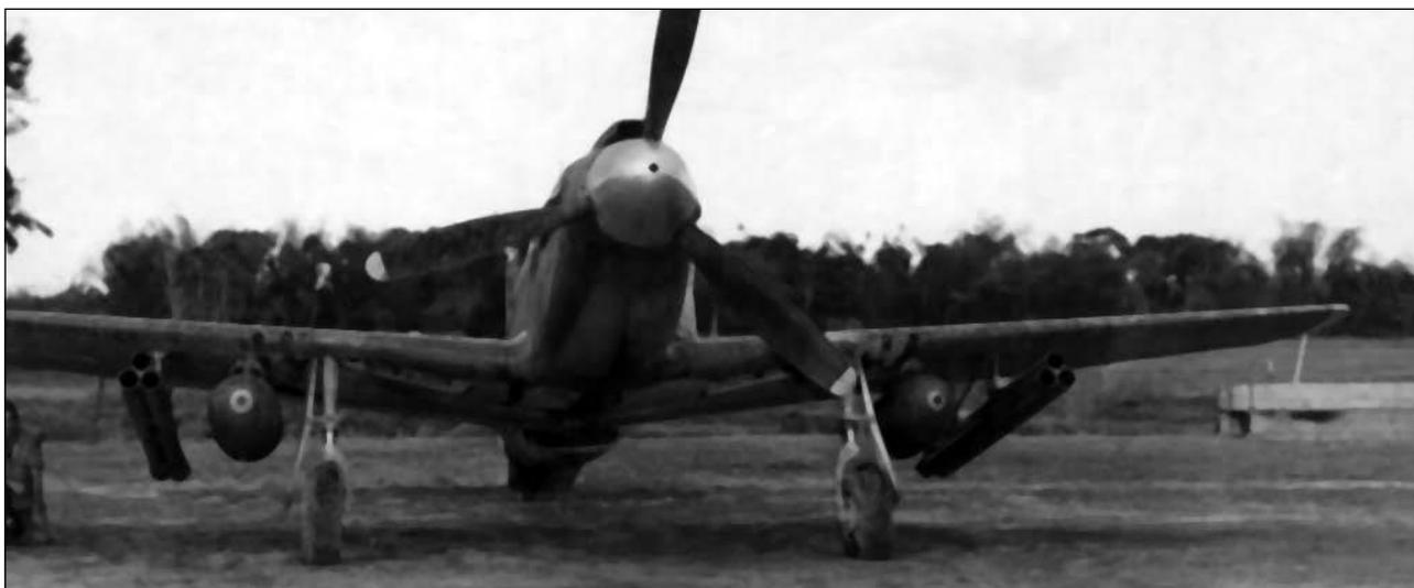
*«P-51 Мустанг», со строенными пусковыми трубами для ракет М-8. Август 1944 г.*
