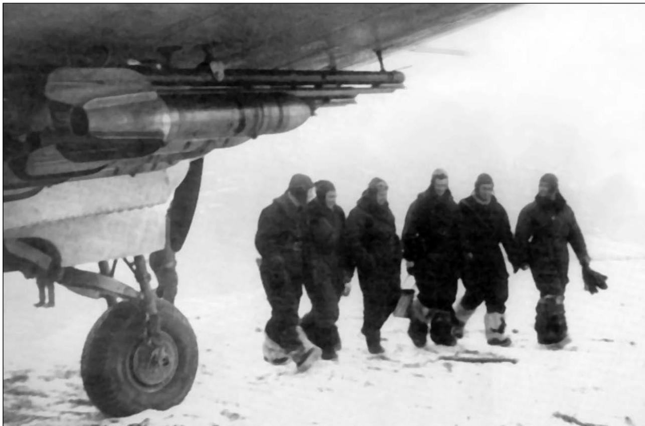
Снаряды РС-132 под крылом самолёта Ил-2 из 312-го штурмового авиационного полка. Зима 1941/42 г. (?).
