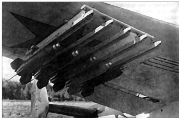
5 реактивных снарядов РС-82 под крылом самолёта Пе-2.
