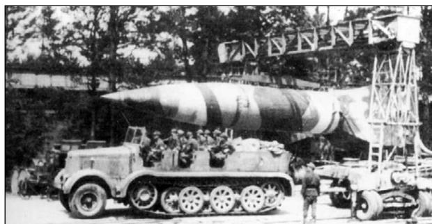
**Боевая Фау-2 с помощью козлового крана устанавливается на тележку. Видны траверса и ремни, с помощью которых выполняется подъём. На переднем плане — тягач с отделением охраны. Стартовая команда занята погрузкой.**
