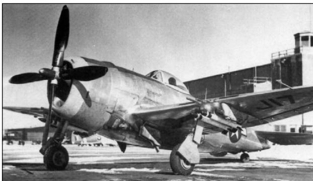
**Одна из последних версий «Тандерболта P-47D», вооружённая ракетами «Холи Мозес». Ракета имеет серый корпус, чёрные стабилизаторы и чёрную с серой полосой боевую часть. Пусковая установки сделана в виде довольно высокого пилота, причём передний штифт ракеты расположен примерно на середине его длины. Так что ракета висит на ПУ в виде консоли. 9-я Воздушная армия в Европе, 1945 г.**
