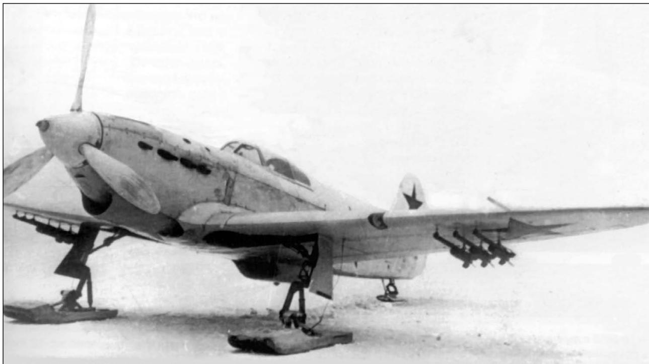
Истребитель Як-1 в зимнем камуфляже и на лыжах. Под крылом 6 снарядов РС-82.
