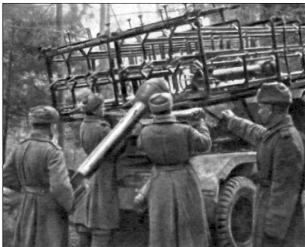
**Заряжание установки БМ-31-12. Хотя установка не имеет спиральных направляющих, заряжается она снарядами М-31УК – «улучшенной кучности». Если присмотреться, то за БЧ можно увидеть штуцеры для проворота снаряда. При зарядке два бойца брали деревянный брус и подкладывали его под БЧ, а третий – брался за стабилизатор. Четвёртый номер открывал замок на ПУ.**
