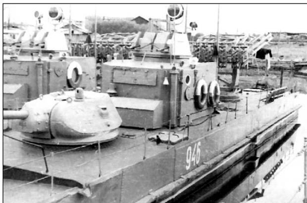
**Бронекатер пр. 1124 с пусковой установкой 16-М-13 для 132-мм реактивных снарядов. На переднем плане бронекатер № 946.**
