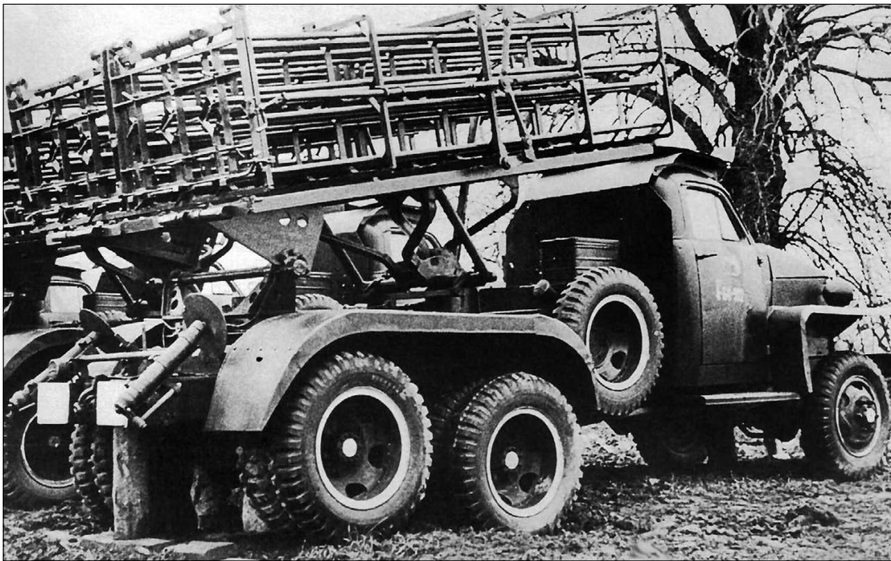
БМ-31-12 на шасси автомобиля «Студебекер» на базе хранения. Прибалтика, 16 ноября 1945 г.
