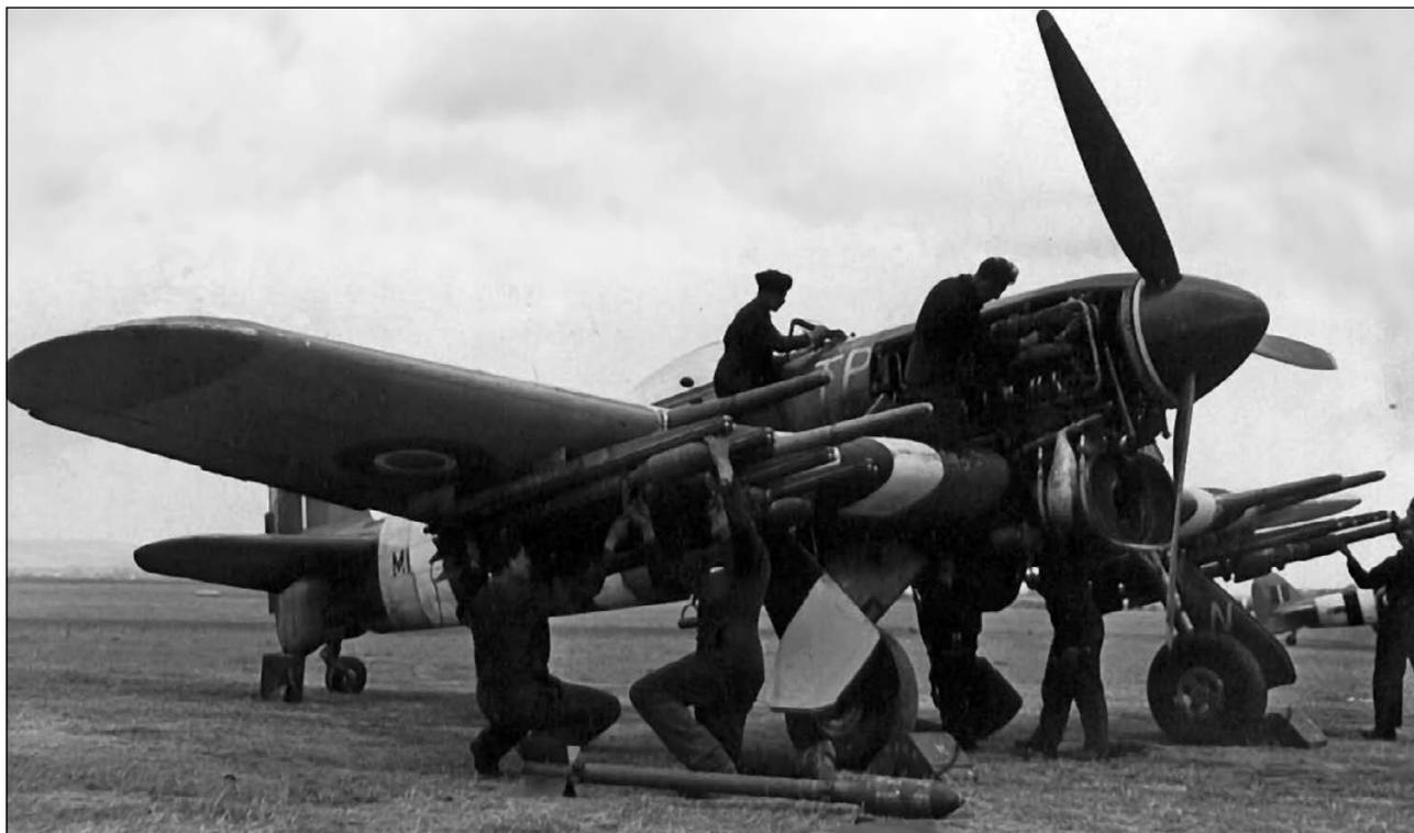
**Истребитель «Тайфун» в штурмовом варианте. Кадр постановочный: мотористы ещё занимаются двигателем, а оружейники уже подвешивают ракеты RP с 60-фунтовой (27 кг) БЧ. Фото: LIFE.**
