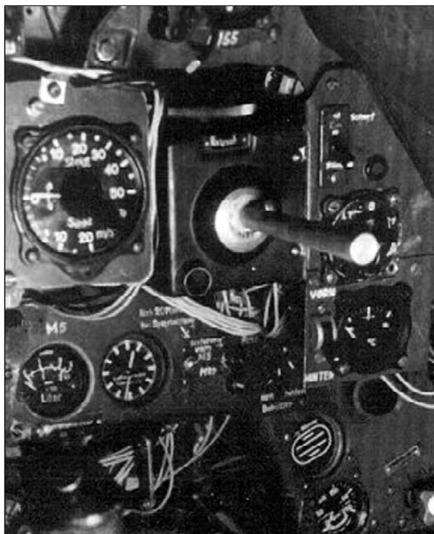
**Приборная доска Fw 190. Виден «кнопфель», с помощью которого пилот управлял полётом ракеты X-4.**
