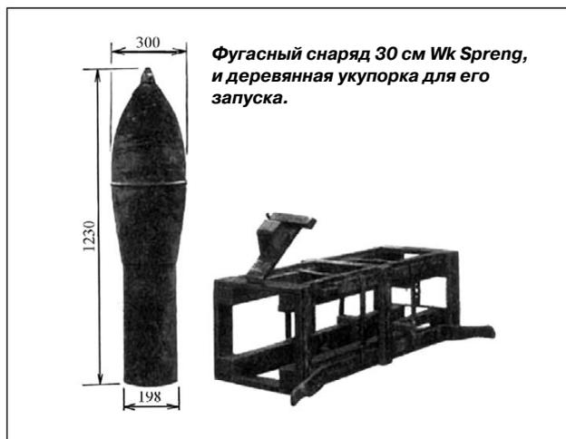
Фугасный снаряд 30 см Wk Spreng, и деревянная укупорка для его запуска.
