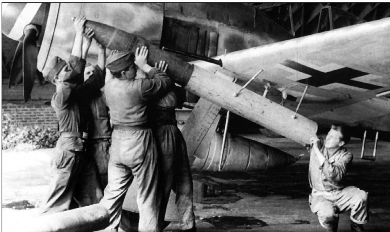
**Зарядание ракеты WGr 21 в пусковую установку «Рустзац 6», установленную под крылом Fw 190. Виден крючок бомбодержателя, на котором висит ПУ. Четыре распорки с резиновыми наконечниками фиксируют трубу и позволяют регулировать направление её оси. После выстрела установку можно сбросить.**
