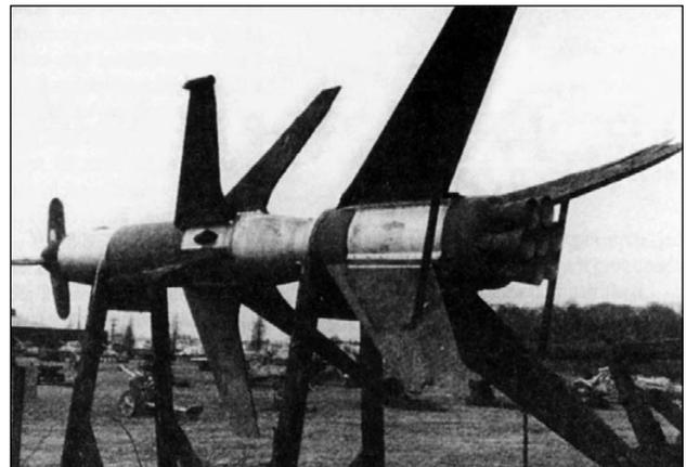
**Ракета «Рейнтохтер R-1». Вид сзади. Хорошо виден стартовый ускоритель, крепление стабилизаторов на уголках, их подкосы, сопла двигателей и повреждения на двух перьях стабилизатора.**
