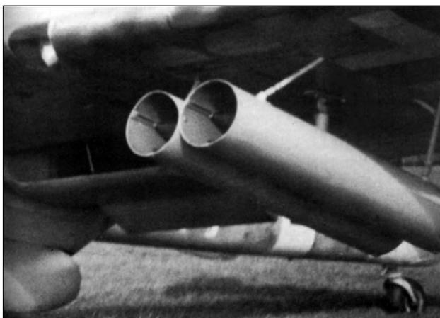
*Спаренная установка для запуска ракет WGr 21, кал. 210-мм, установленная под крылом истребителя Bf 110G. В трубах видны рейки, придающие снаряду вращение. Лето 1943 г.*
