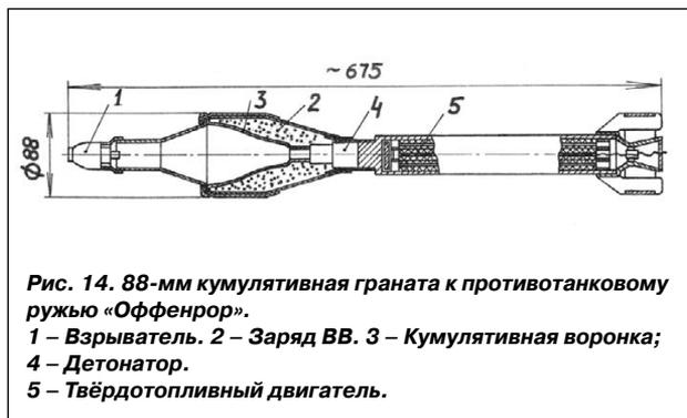
**Рис. 14. 88-мм кумулятивная граната к противотанковому ружью «Оффенрор».**
