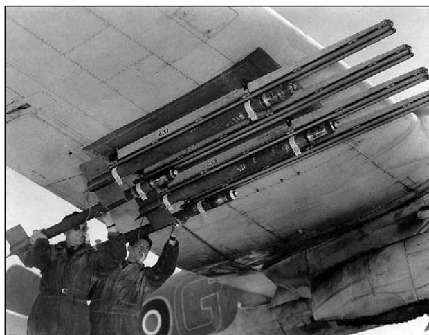
**Установка бронейной ракеты с 25-фунтовой головкой (11,3 кг) на самолёт Бофайтер Mk.X. Направляющие штифты на ракетах (белого цвета) сделаны из двух штампков из полосы, стянутых болтами. Направляющий паз на пусковой установке сделан из двух трубок. Ракеты могли запускаться парами (по одной с каждого крыла) или залпом.**
