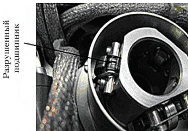
Рис. 5. Разрушение подшипника узла вторичного зеркала
