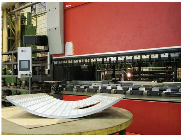
Рис. 3. Элемент конической обечайки (с вафельной оболочкой)
