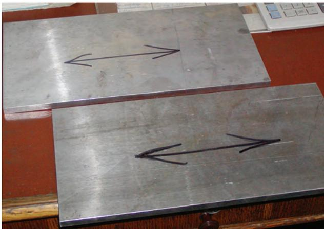
Рис. 1. Заготовки для образцов под сварку. Стрелками указано направление проката
