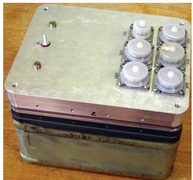
*Рис. 1. Макет корпуса электронного прибора перспективных изделий ракетно-космической техники*
