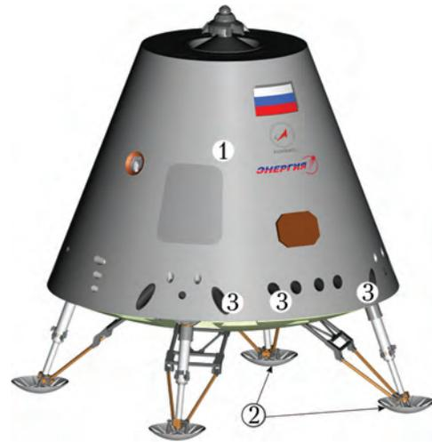
**Рис. 6. Возвращаемый аппарат пилотируемого транспортного корабля с выпущенным посадочным устройством:** 1 – корпус возвращаемого аппарата; 2 – посадочные опоры посадочного устройства; 3 – сопла посадочной твердотопливной двигательной установки
