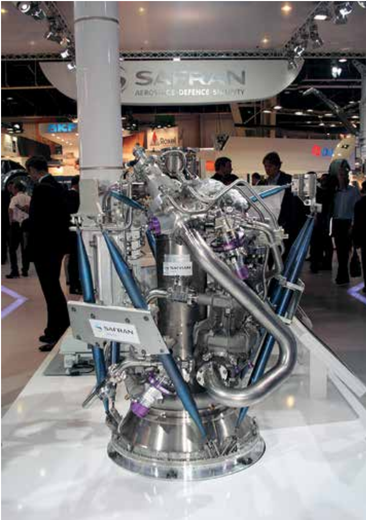
Водородно-кислородный двигатель «Винчи»
