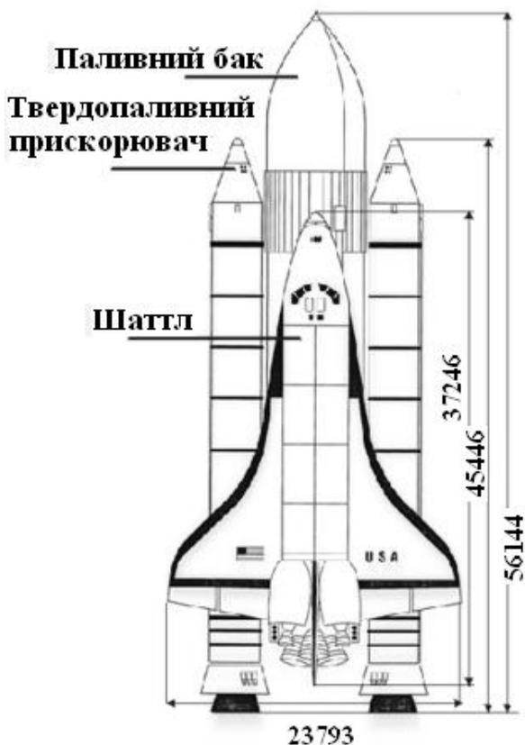
Рис.61. Многоразовая транспортная космическая система "Спейс Шаттл" ("Space Shuttle").
