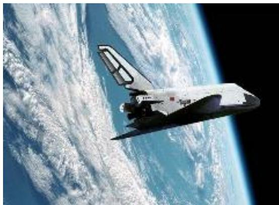
Рис.23. Космический многоразовый корабль «Буран» на низкой орбите Земли. Длина: 36,4 м; высота: 16 м; размах крыльев: 24 м; масса собственная: 105 т; выводит на орбиту полезную нагрузку 30 т; спускает с орбиты 20 т; экипаж: до 10 чел.; посадочная скорость 300 км/ч; граничная скорость входа в земную атмосферу 30000 км/ч. Всего производилось 5 изделий [33].
