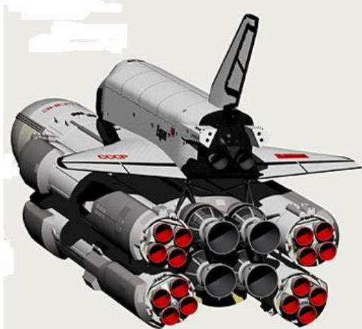
Рис.60. Окончательный вариант комплекса «Энергия-Буран» (начиная с марта 1978 г.): четыре керосиновых двигателя РД-170 (первая ступень носителя «Энергия»); четыре водородных двигателя второй ступени; бак топлива и окислителя (жидкий кислород); маршевые двигатели «Бурана» обеспечивают третью ступень для выведения в космос и управления вместе с двигателями ориентации [29,33].
