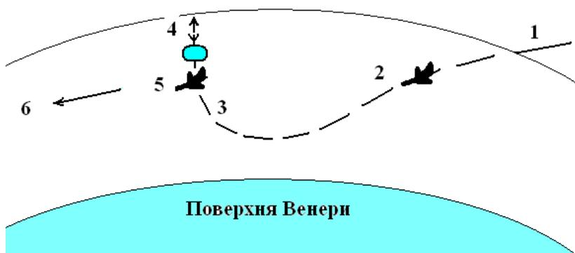
Рис.27. Этапы создания аэростатной станции: 1 – перед входом в плотные слои атмосферы; 2 – активный участок торможения; 3 - выход на вертикаль; 4 – раскрытие и наполнение баллонов водородом; 5 – стабилизация на высотах свыше 50 км; 6 – начало дрейфа.
