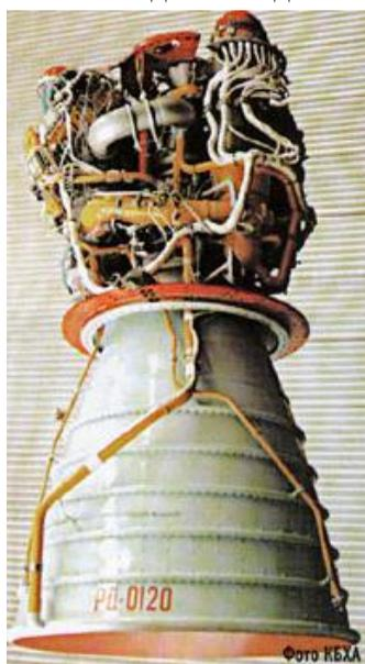
Рис.56. Кислородно-водородный криогенный двигатель РД-0120 для высших ступеней сверхмощных ракет-носителей – одна из последних разработок для ракеты «Энергия».
