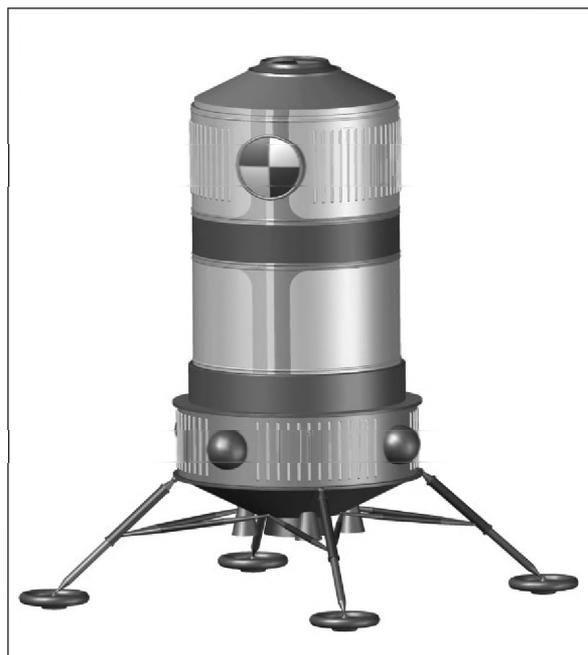
*Модуль станции «Звезда» на посадочной ступени*
