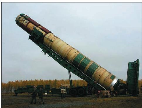
Установка МБР Р-36М в шахтную пусковую установку.
