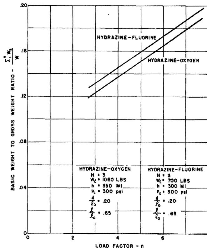
BASIC WEIGHT TO GROSS WEIGHT RATIO VS AXIAL LOAD FACTOR
