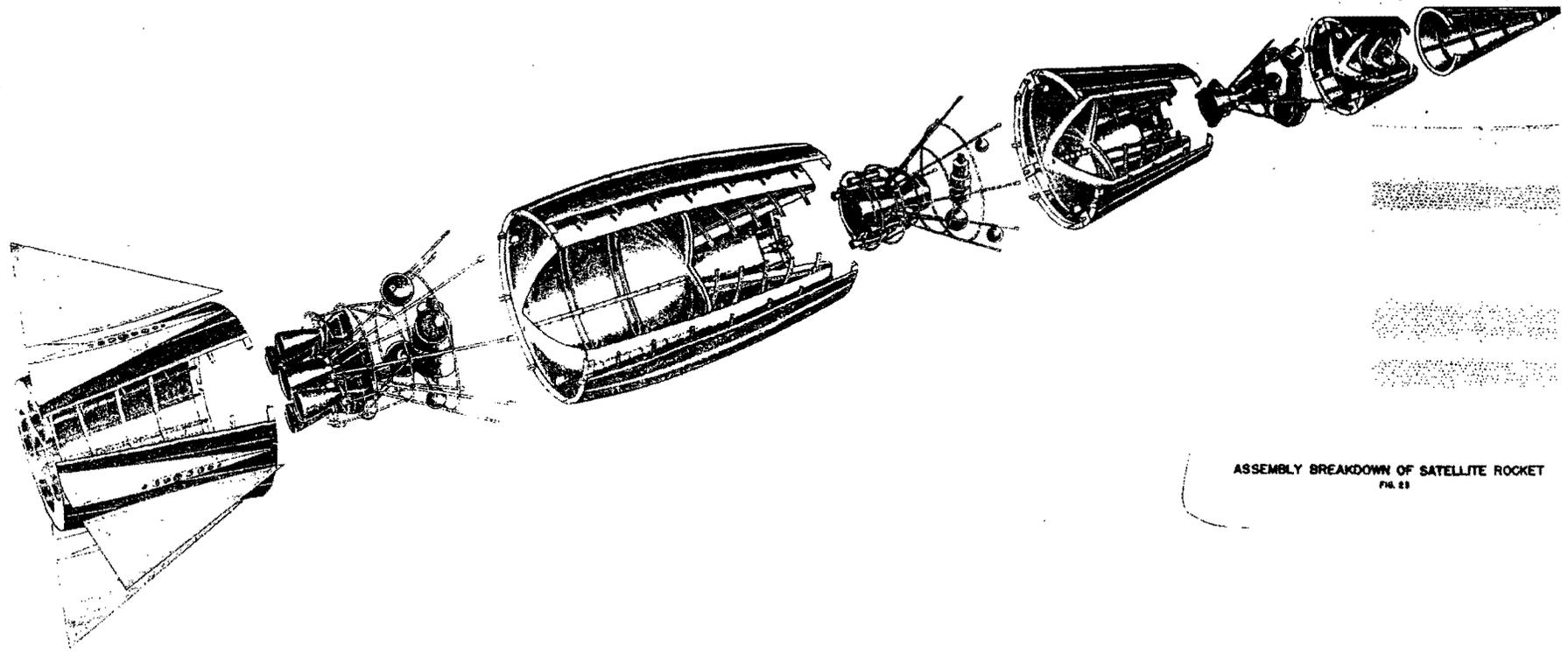
ASSEMBLY BREAKDOWN OF SATELLITE ROCKET
