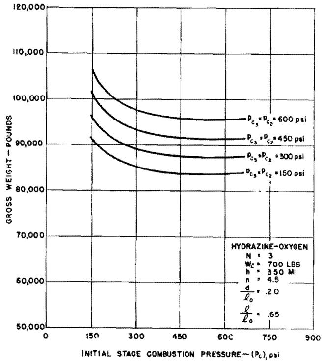
GROSS WEIGHT vs COMBUSTION PRESSURE
