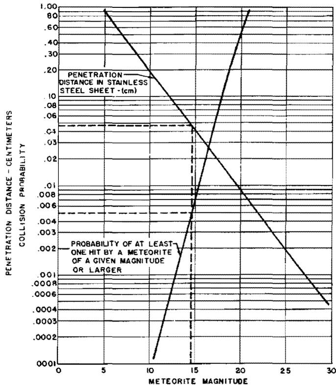
SATELLITE ROCKET-METEORITE COLLISION PROBABILITY AND METEORITE PENETRATION VS METEORITE MAGNITUDE
