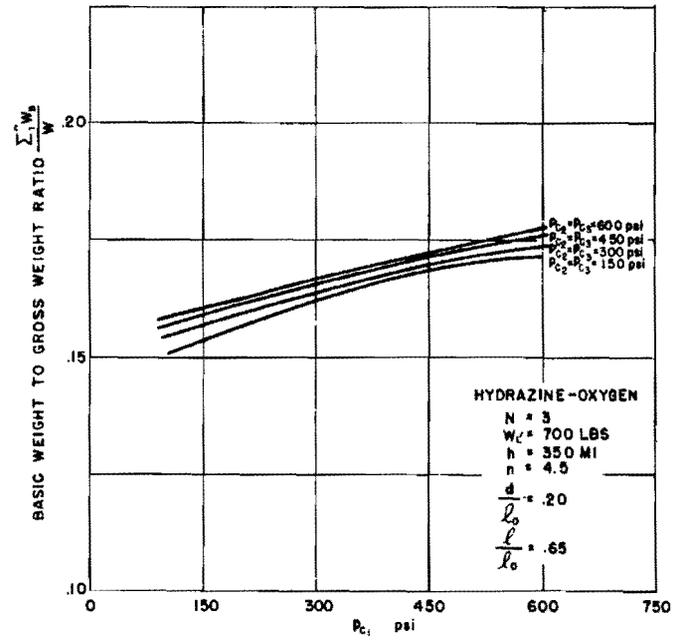
BASIC WEIGHT TO GROSS WEIGHT RATIO vs COMBUSTION PRESSURE
