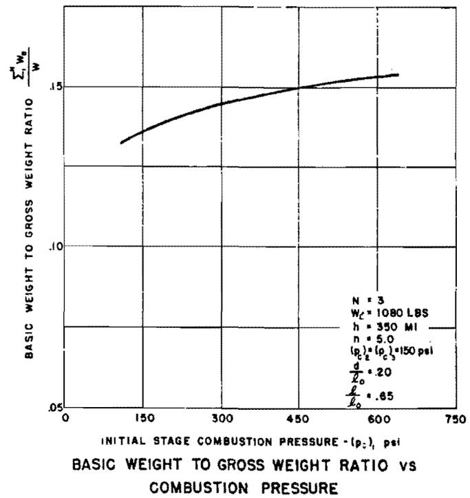
BASIC WEIGHT TO GROSS WEIGHT RATIO VS COMBUSTION PRESSURE
