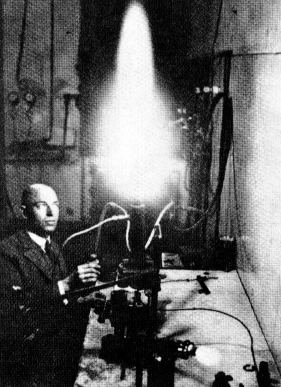
Valier legt Gewichte auf die Waagschale, um die Rückstoßkraft zu messen.
