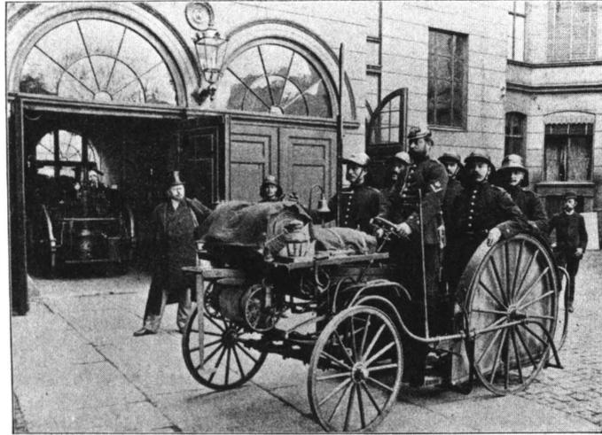
Bild 8. Tretmotor-Feuerwehrwagen bei der Berliner Feuerwehr in Funktion (1895)
