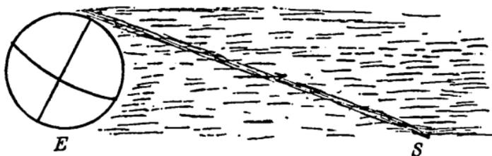
Abb. 19. Wirkungsweise des Spiegels. S = der Spiegel, E = die Erde,  $\rightarrow$  = Richtung zur Sonne. (In der Zeichnung steht der Spiegel so, daß die von ihm reflektierten Strahlen über den Nordpol hinweg in den Raum gehen).
