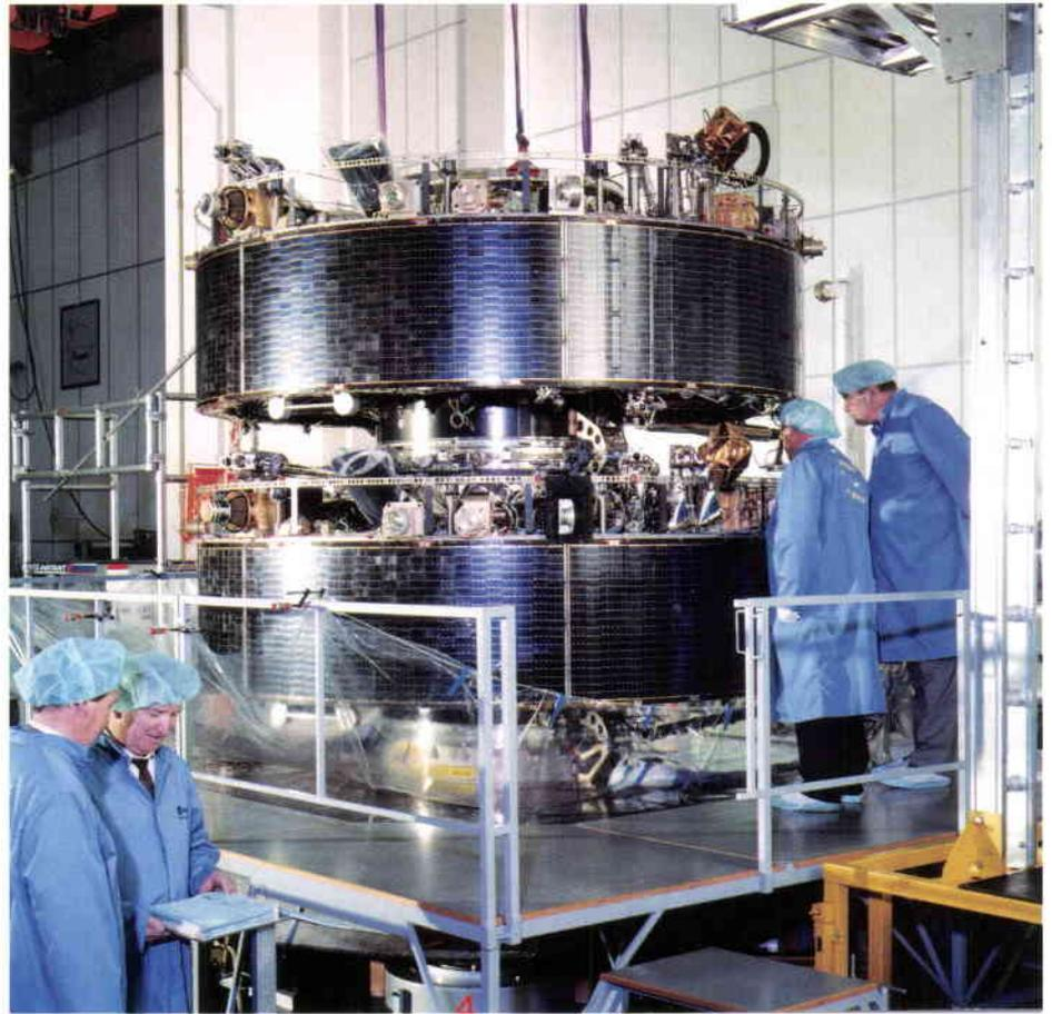
*électromagnétique. A la suite de ces essais, le satellite et la charge utile seront remis en état et préparés pour le lancement.*
