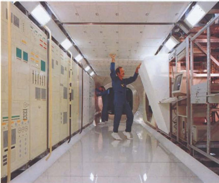
**Figure 1. Maquette de l'intérieur du Laboratoire attaché en grandeur nature. Dr Wubbo Ockels, un des astronautes européens, fait basculer un des racks qui composeront l'aménagement du laboratoire**
