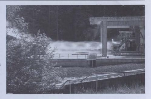
durée (2 s) ont ensuite été exécutés sur la chambre équipée de son divergent et un troisième est en préparation. L'objectif des prochains essais est de parvenir à une durée de combustion de l'ordre de 20 s. Testing of the combustion chamber for the Ariane-5 Vulcain engine at Lampoldshausen (D)
