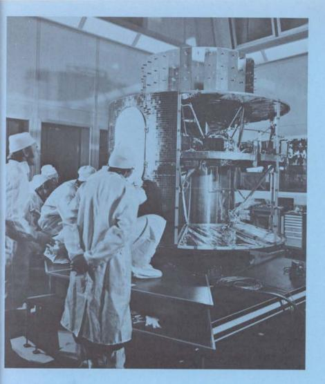
Montage des panneaux solaires sur le prototype de Météosat.
