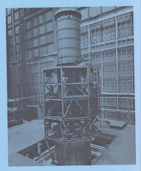
Mise en place d'ISEE-B dans la chambre HBF3 de l'ESTEC pour les essais de bilan thermique/sous vide thermique.
