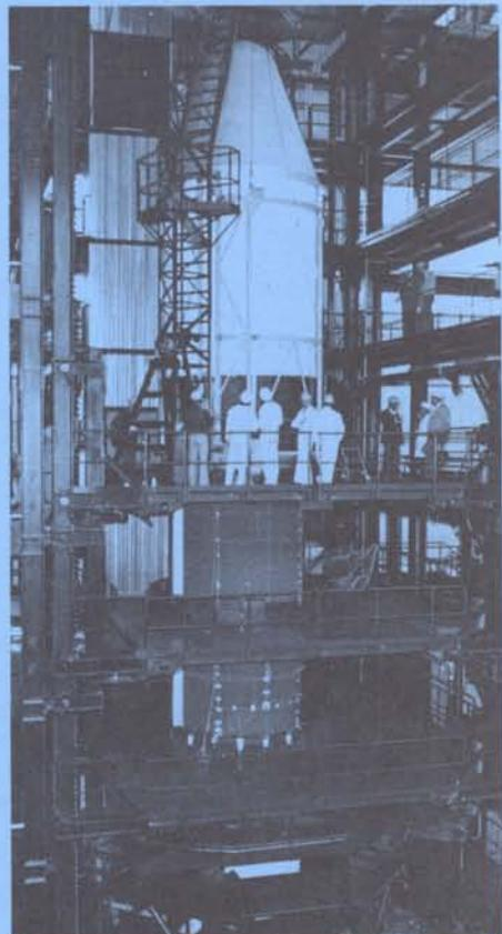
*Essais de la maquette dynamique en configuration 2ème étage, 3ème étage et coiffe au Site d'Intégration Lanceur.*
