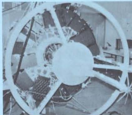
*Modèle d'intégration d'ISEE pendant les essais du système intégré chez Dornier.*
