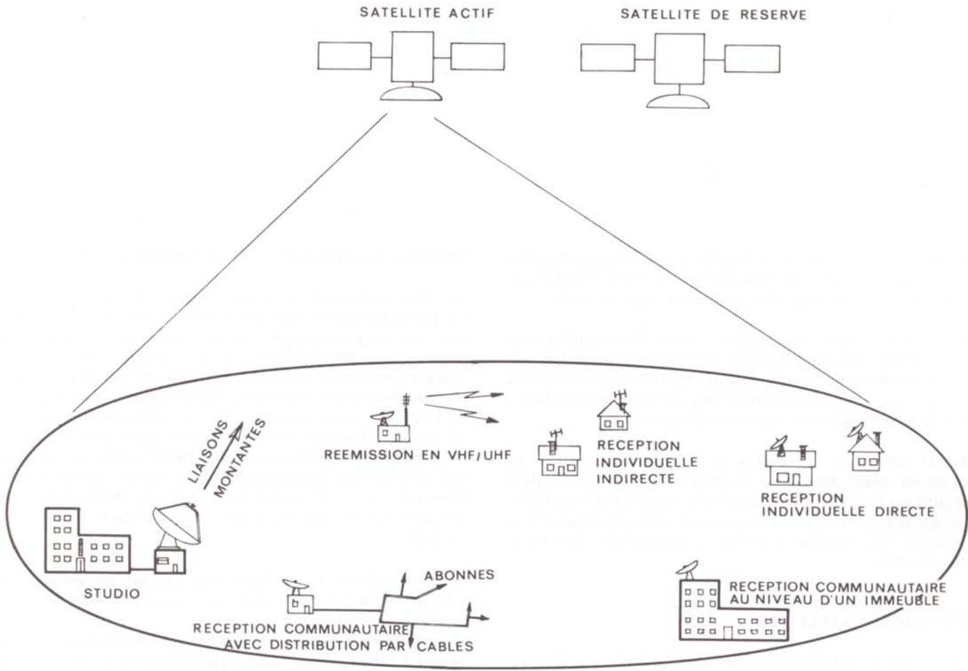
Figure 1 – Un système de radiodiffusion par satellites
