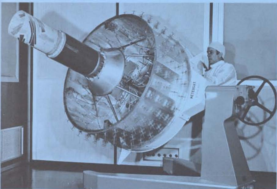
Assemblage du sous-système d'antenne de Meteosat.
