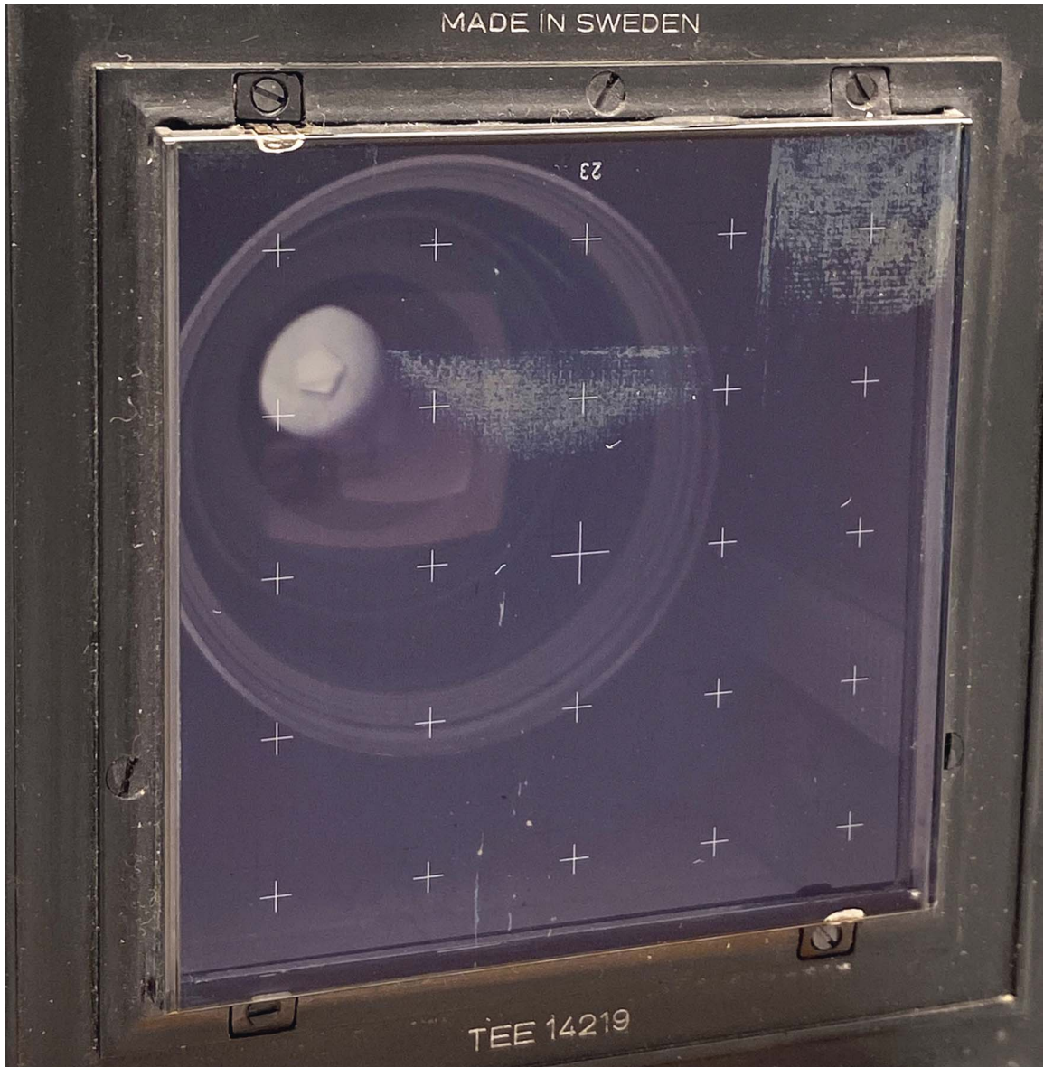
CLOSE-UP OF THE HDC'S RÉSEAU PLATE
