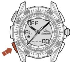
После выбора отображаемой функции AL<sub>1</sub>, AL<sub>2</sub>, или AL<sub>3</sub> войдите в режим программирования
