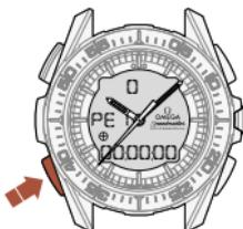
После выбора отображаемой функции РЕ 1, РЕ2, или РЕ3 войдите в режим программирования
