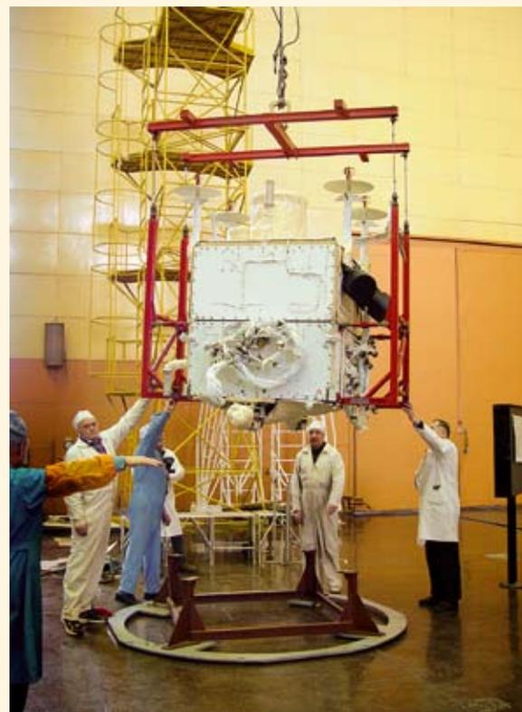
▲ **Сборка и проверка работоспособности аппаратуры космического аппарата «Монитор-Э» в цехе ГKNПЦ им. М.В. Хруничева**
