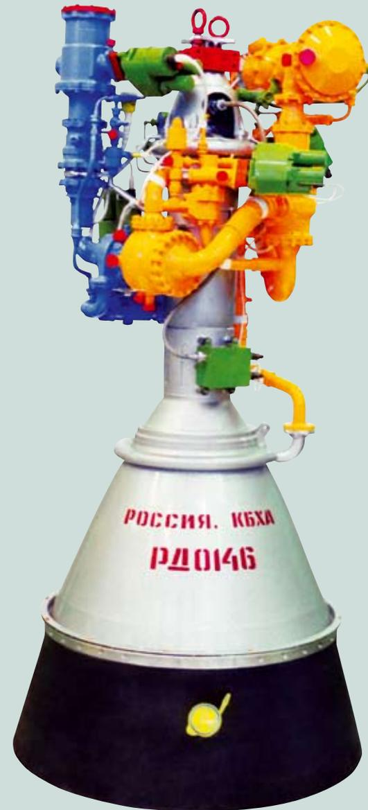
▲ Двигатель РД-0146 третьей ступени ракеты-носителя «Протон» разработки КБХА
