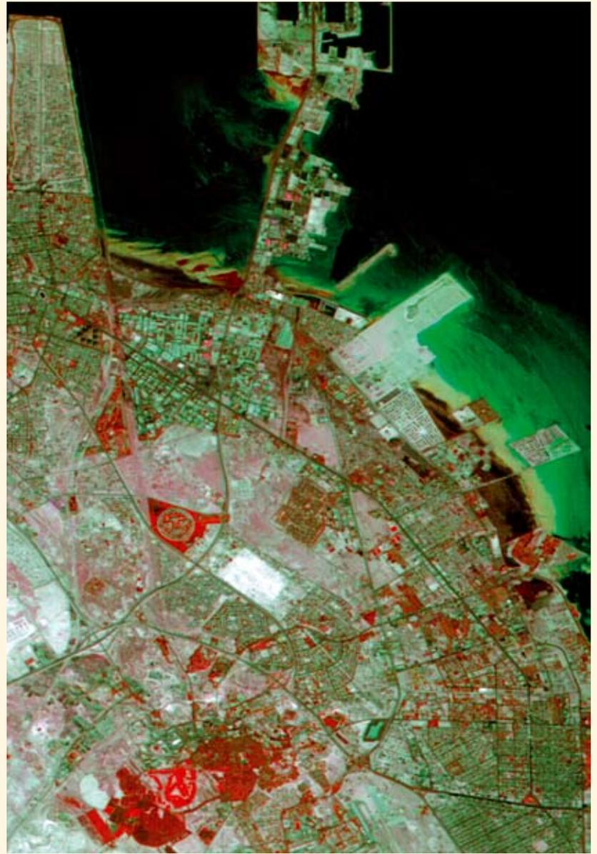
▲ Снимок земной поверхности, выполненный с космического аппарата «Монитор-Э» камерой аппаратуры распределенного доступа «Гамма-Ц» в видимом цветном диапазоне спектра с разрешением 20 м
