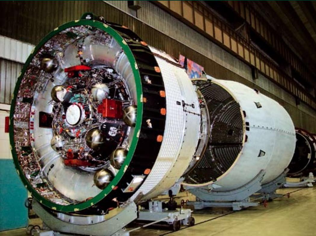
▲ Разгонный блок «Бриз-М» подготовлен к стыковке с третьей ступенью РН «Протон», к проверке крепления и накатке обтекателя космической головной части
