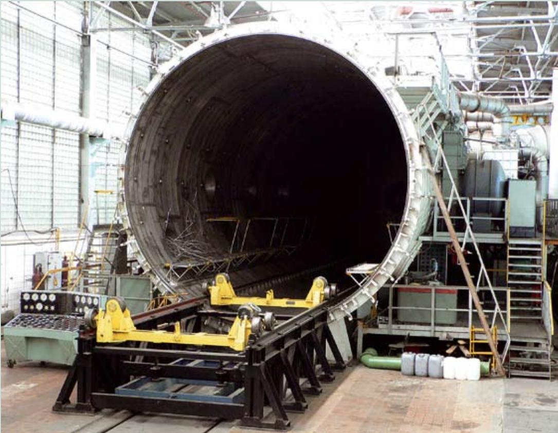
▲ **Корпус первой ступени на линии сборки ракеты-носителя «Протон»**
