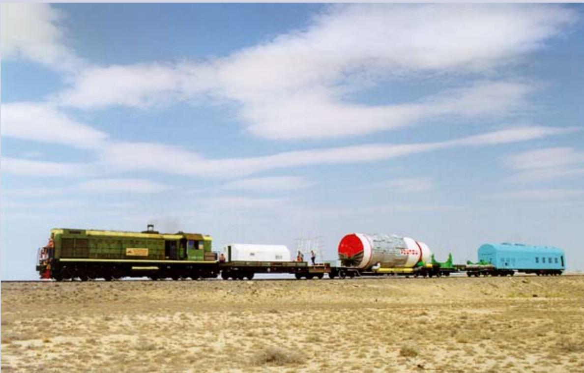
◀ Транспортировка служебного модуля «Звезда» после окончательной сборки и проверок из МИКа для стыковки с ракетой-носителем «Протон»
