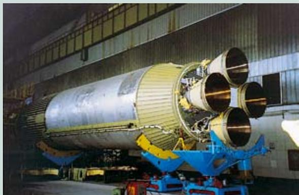
◀ **Вторая ступень «Протона» в цехе ракетно-космического завода ГКНПЦ им. М.В. Хруничева. Вид со стороны двигателей**
