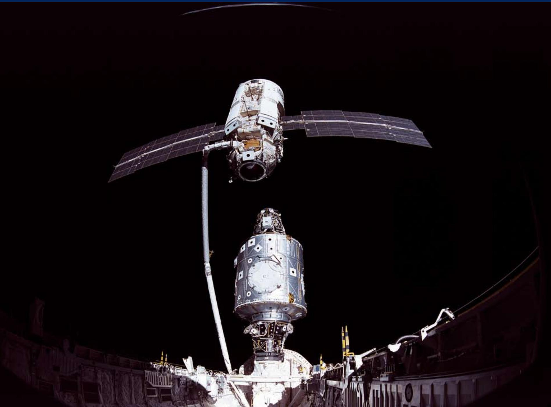
▲ Процесс сближения американского космического корабля «Индевор» с модулем «Заря», изъятия манипулятором стыковочного узла «Юнити» из транспортного отсека, сближения и стыковки «Зари» и «Юнити»
