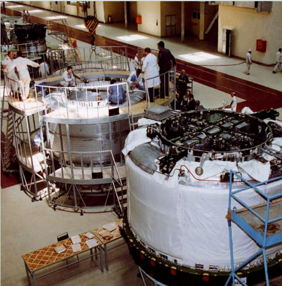
◀ Линия серийного производства разгонных блоков «Бриз-М» в цехе ракетно-космического завода ГКНПЦ им. М.В. Хруничева
