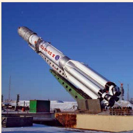
**Ракета-носитель переведена в вертикальное положение и закреплена на стартовом столе**
