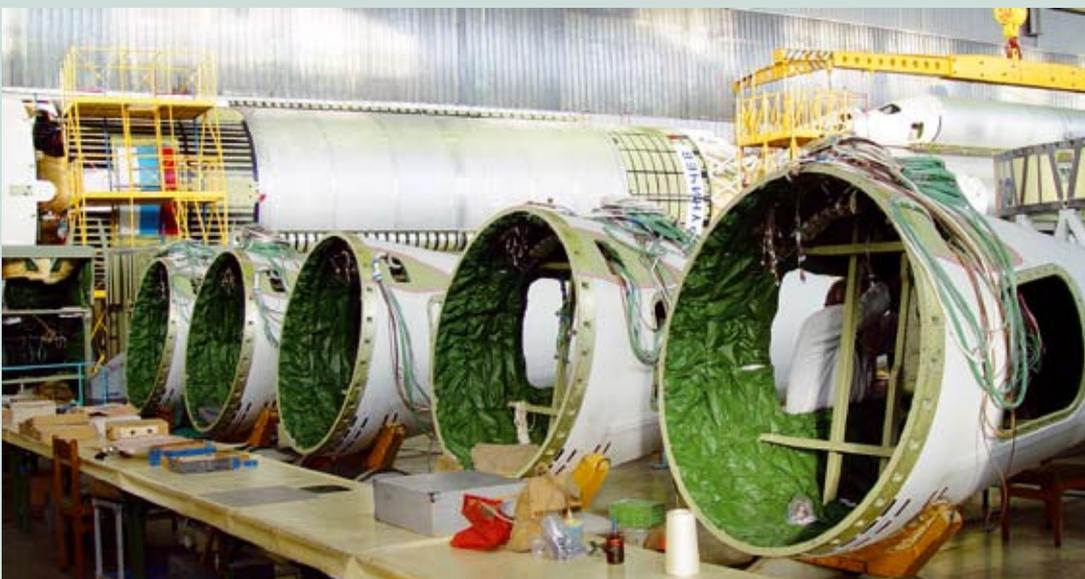
◀ **Монтаж аппаратуры, проверка и подготовка элементов первой ступени ракеты-носителя «Протон» к сборке в блок первой ступени в цехе ракетно-космического завода**
