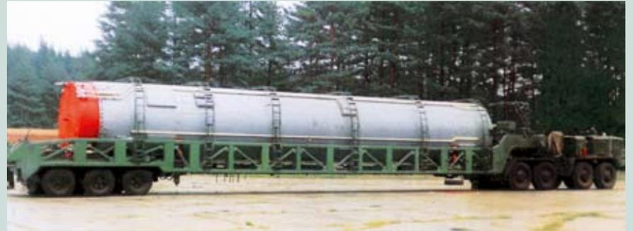
▲ **Транспортировка контейнера с МБР УР-100 из хранилища боевых ракет к шахтной пусковой установке**
