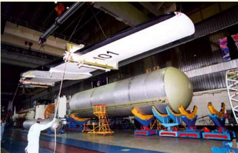
◀ **Транспортировка складного крыла перед сборкой с корпусом ускорителя**
