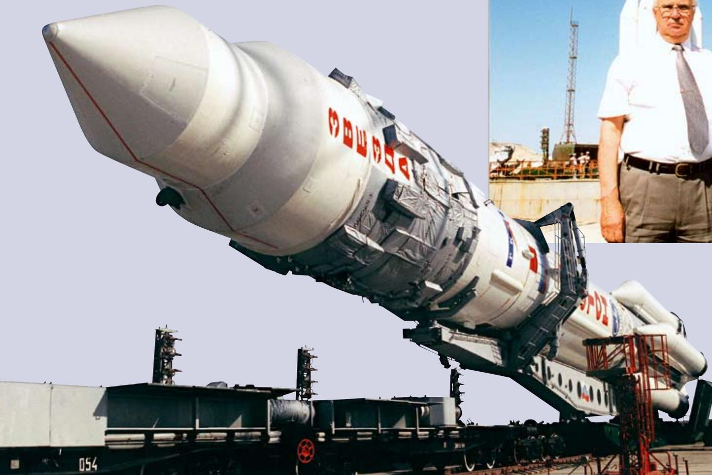
▶ Подъем ракеты-носителя «Протон» с пристыкованным служебным модулем «Звезда» на стартовом комплексе в вертикальное положение с помощью транспортно-подъемного устройства
