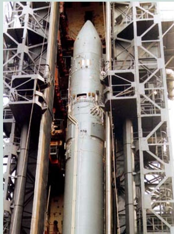
◀ **Космическая головная часть состыкована с ракетой-носителем и зафиксирована в башне обслуживания**
