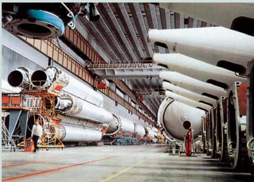
**Подготовка корпусов двигателей первой ступени ракеты-носителя «Протон» к сборке**
