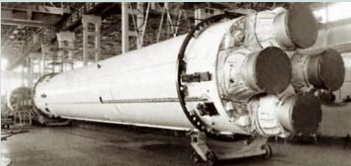
▲ **МБР УР-100Н на монтажных тележках в цехе завода – вид со стороны блока двигателей первой ступени**
