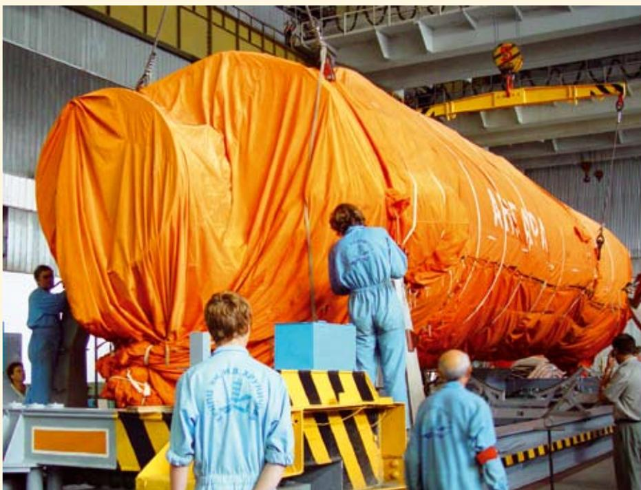
◀ **Перегрузка ракеты-носителя «Ангара» перед отправкой на испытания**
