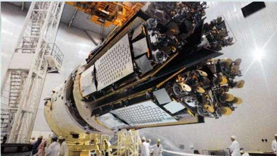
▲ **Подготовка в МИКе на Байконуре космических аппаратов системы глобальной спутниковой связи Iridium. Одним пуском ракета-носитель «Протон» выводит на орбиты семь спутников этой системы**
