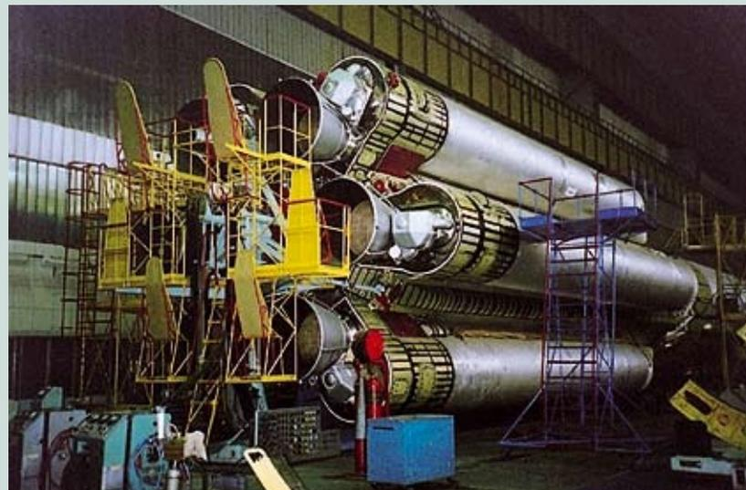
**Первая ступень «Протона» в сборе с шестью жидкостными ракетными двигателями РД-253 в цехе ракетно-космического завода ГНПЦ им. М.В. Хруничева**
