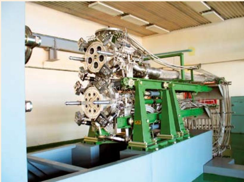
▲ **Агрегат автоматической стыковки криогенных коммуникаций**
