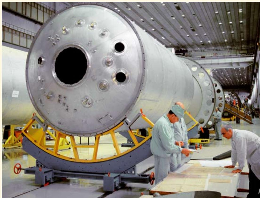
**Сборка корпуса универсального ракетного модуля ракеты-носителя «Ангара» в одном из цехов ГКНПЦ им. М.В. Хруничева**
