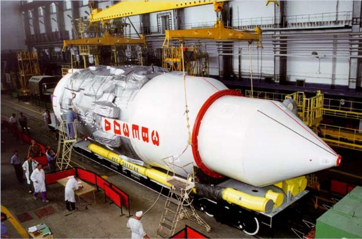
◀ Служебный модуль «Звезда» подготовлен к транспортировке для стыковки с ракетой-носителем «Протон»
