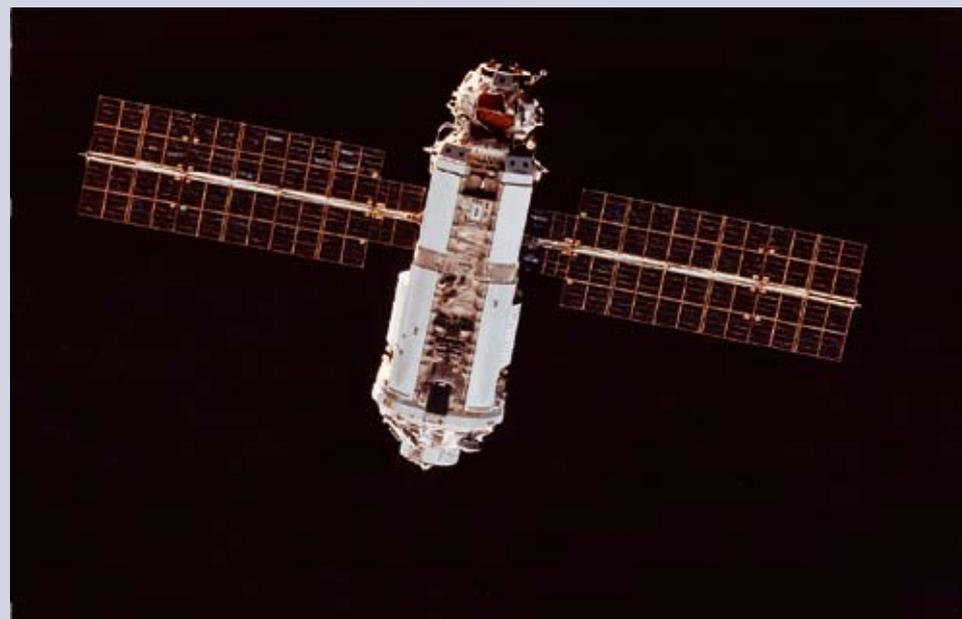
▲ **Первый структурный элемент Международной космической станции – функциональный грузовой блок – модуль «Альфа» – в полете в открытом космосе. Фотография, выполненная с автоматического корабля «Прогресс».**
