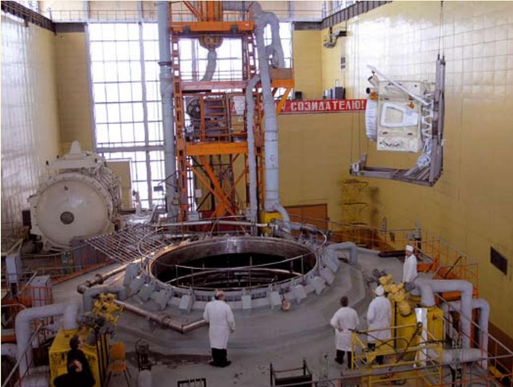
◀ **Подготовка космического аппарата «Казсат» к испытаниям в условиях, близких к космическим, в барокамере НИИХИММАШ**
