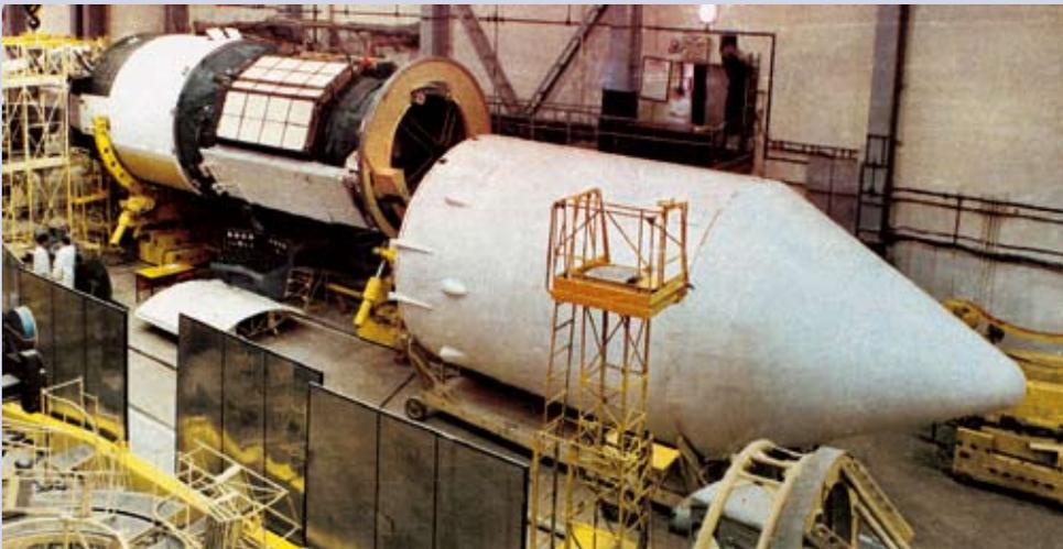
▲ **Подготовка автоматической орбитальной станции «Алмаз» (искусственный спутник Земли «Космос-1870») в монтажно-испытательном корпусе на космодроме Байконур**
