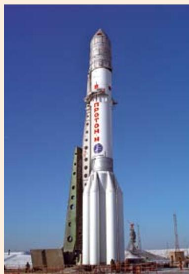
**Отвод транспортно-подъемного устройства от ракеты-носителя «Протон М»**
