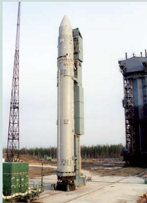
▶ **Закончены контрольные проверки ракеты-носителя и космической головной части. Начат отвод башни обслуживания от стартового стола**
