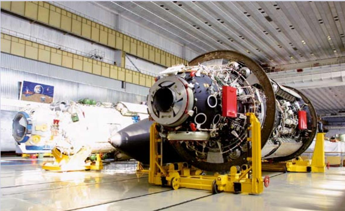
◀ ФГБ-2 (многофункциональный лабораторный модуль) в сборочном цехе ГКНПЦ им. М.В. Хруничева
