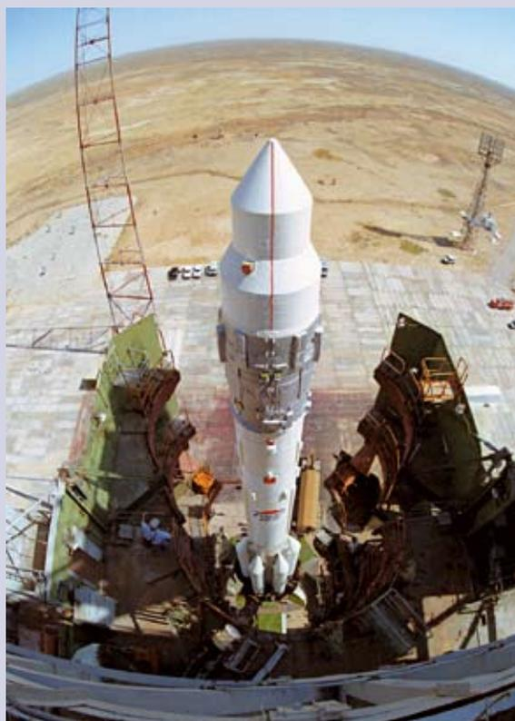
▶ Ракета-носитель «Протон» со служебным модулем «Звезда» зафиксирована в вертикальном положении на стартовом столе. Подводится ферма обслуживания для выполнения заключительных предстартовых операций
