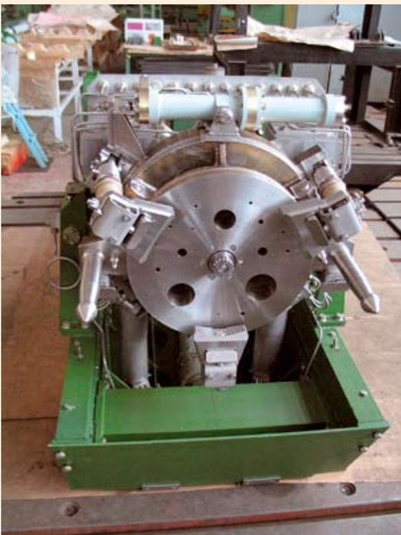
◀ **Узел агрегатов автоматической стыковки ракетно-космического комплекса «Ангара»**
