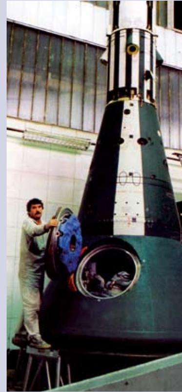
◀ **Стыковка отсека двигательной установки системы аварийного спасения с возвращаемым аппаратом ТКС в МИКе на космодроме Байконур (слева)**
