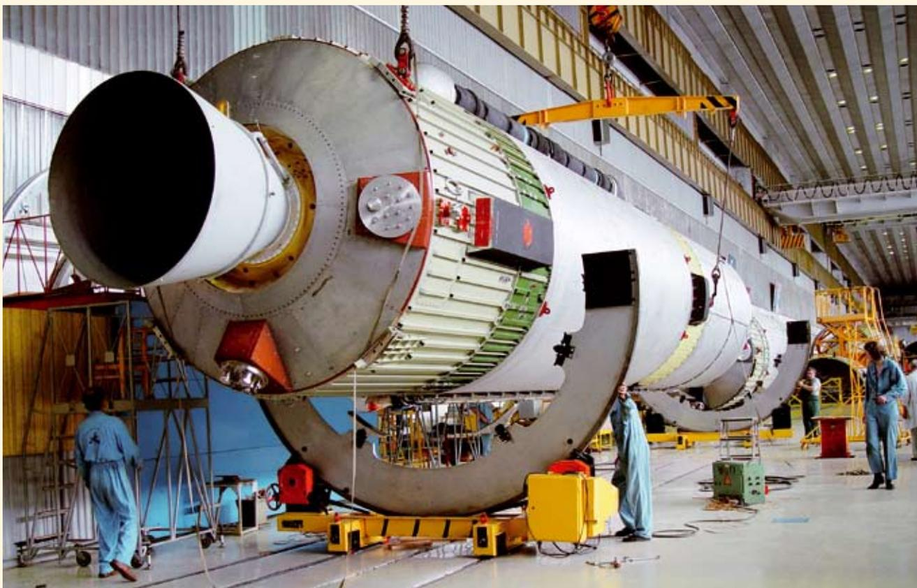
**Жидкостной ракетный двигатель РД-0124А для второй ступени ракеты-носителя «Ангара»**
