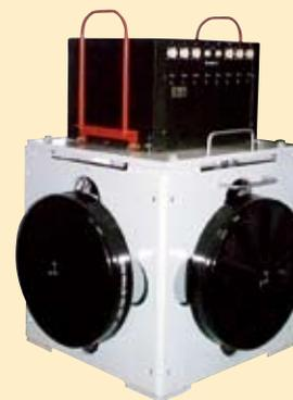
Комплекс управляющих двигателей-маховиков космического аппарата «Казсат» производства ФГУП «НИИ командных приборов»
