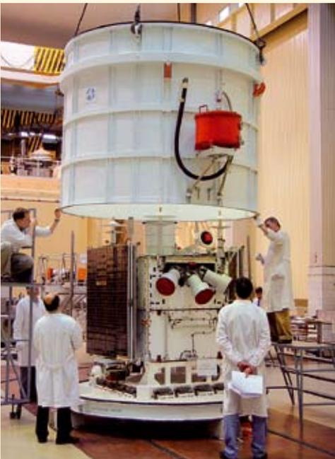
▶ Космический аппарат «Монитор-Э» установлен в испытательной камере в НИИХИММАШ
