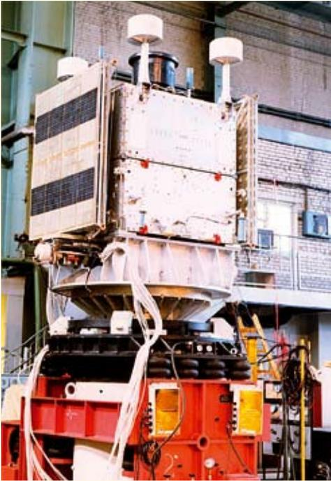
▲ Подготовка аппарата «Монитор-Э» к очередным испытаниям на стенде в ГКНПЦ им. М.В. Хруничева
