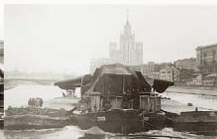
**Погрузка и транспортировка первого опытного самолета 3М №0201 по Москве-реке на специально оборудованных баржах в начале ноября 1955 г. с завода № 23 на летно-испытательную и доводочную базу ЛИ и ДБ в г. Жуковском**
