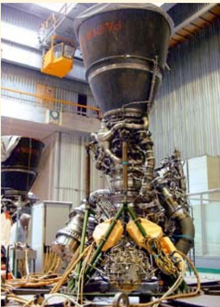
◀ Кислородно-керосиновый двигатель РД-191 производства НПО «Энергомаш» для универсального ракетного модуля первой ступени ракеты-носителя «Ангара»
