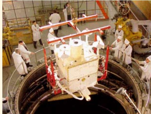
▲ Загрузка космического аппарата «Монитор-Э» в тепловакуумную испытательную камеру в НИИХИММАШ
