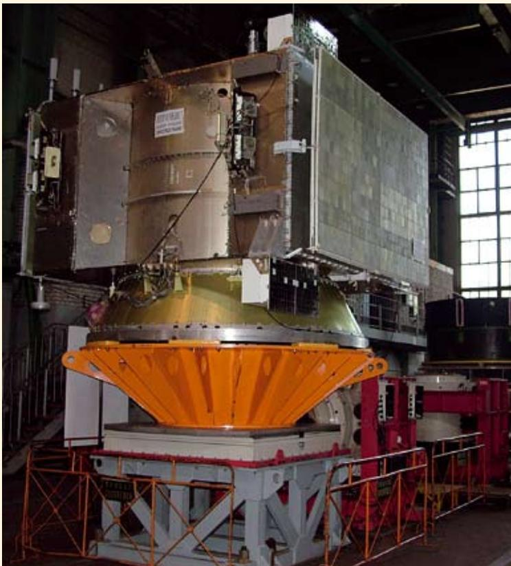
▶ Установка контейнера перед отправкой космического аппарата «Монитор-Э» на испытания
