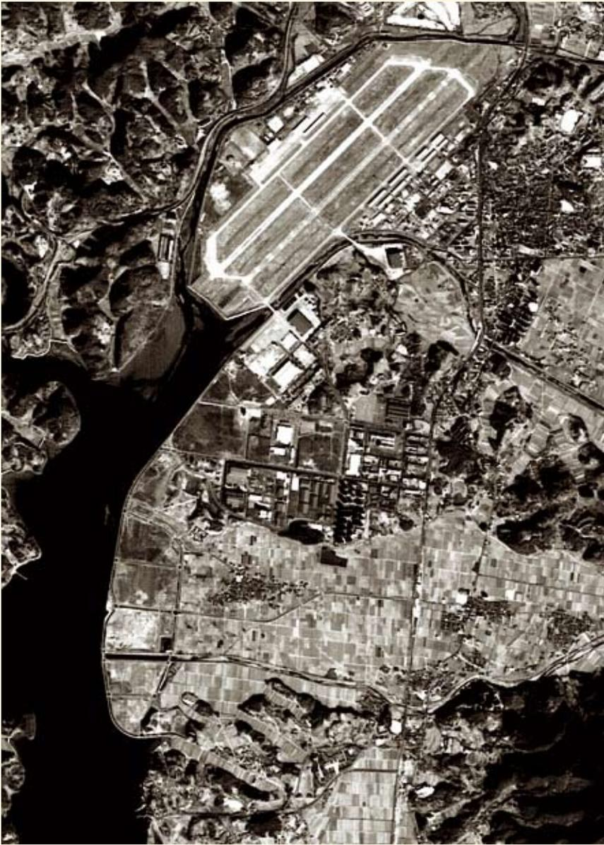
▲ Один из первых панхроматических черно-белых снимков участка земной поверхности, выполненный камерой «Гамма-Л» со спутника «Монитор-Э» с высоты 540 км с разрешением 8 м
