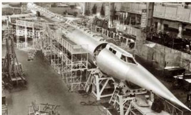
▲ **Сборка первого экземпляра сверхзвукового дальнего бомбардировщика М-50 в цехе завода № 23**
