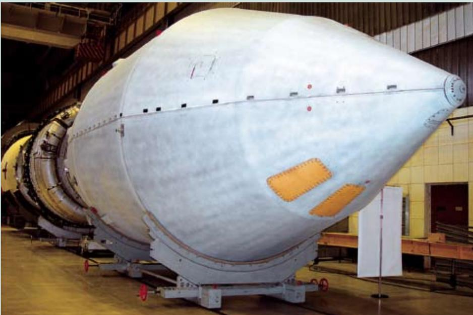
◀ **Ракета-носитель «Протон» в цехе ракетно-космического завода (вид со стороны головного обтекателя)**
