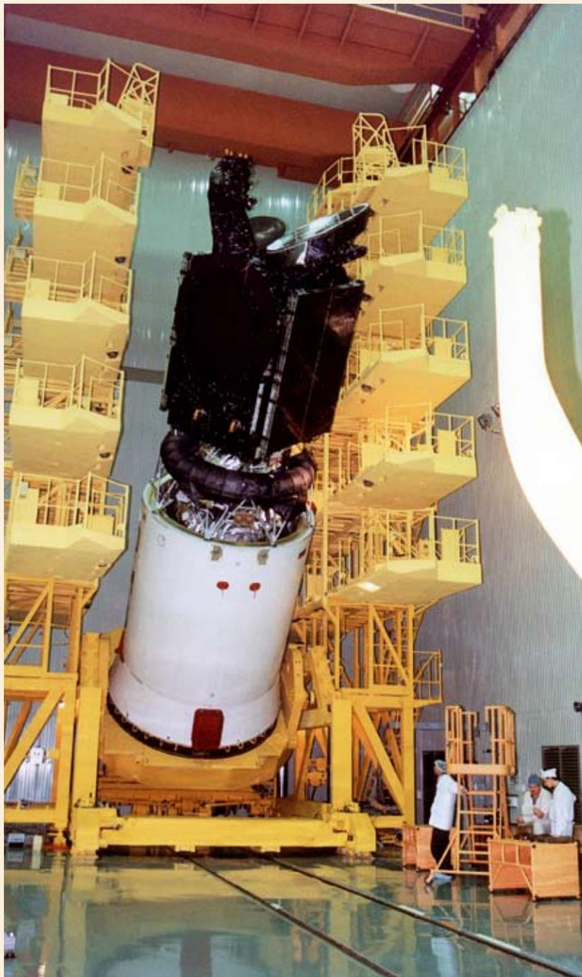
▲ Проверка спутника в «чистом помещении» МИКа 92-50 перед накаткой обтекателя и стыковкой с ракетой-носителем «Протон»
