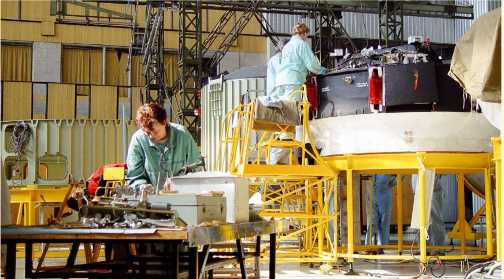
▲ Подготовка и сборка элементов универсального ракетного модуля ракеты-носителя «Ангара»
