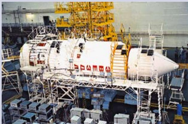
◀ Завершающие операции по подготовке служебного модуля «Звезда» к стыковке с ракетой-носителем «Протон»
