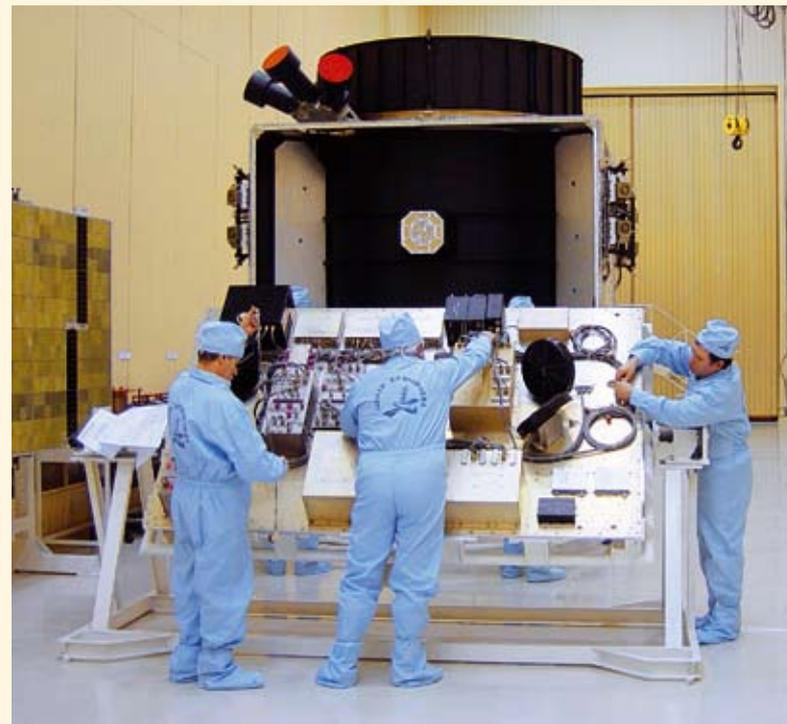
▲ **Подготовка и проведение электрических испытаний космического аппарата «Казсат» в ГКНПЦ им. М.В. Хруничева**
