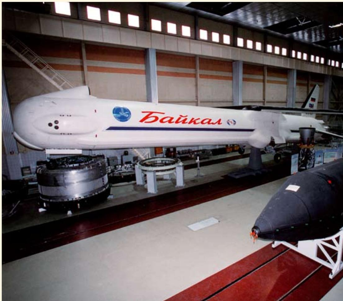
▲ Корпус многоразового ускорителя «Байкал» (без складного крыла) на линии сборки в цехе ГКНПЦ им. М.В. Хруничева. Виды сбоку и сверху
