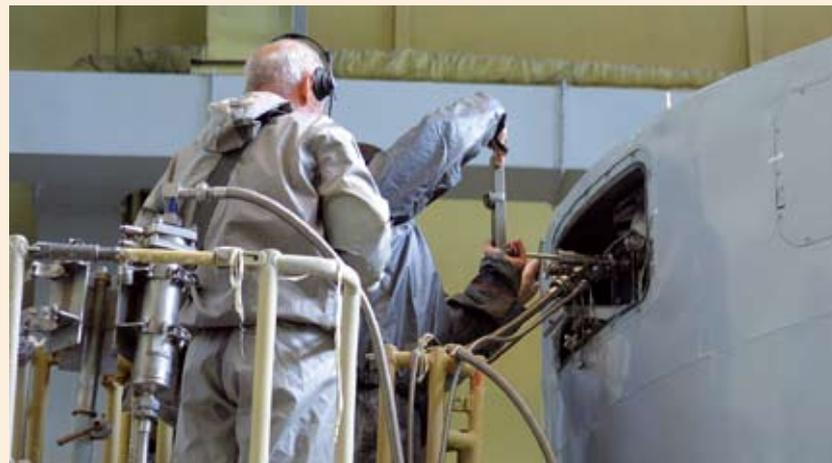
▲ Операции по заправке топливом разгонного блока «Бриз-М» перед стыковкой с ракетой-носителем осуществляют специалисты КБ ТХМ
