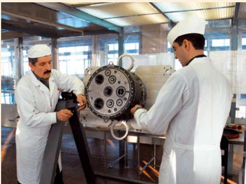
**Координатно-расточная обработка деталей бортовых разъемных систем ракетно-космического комплекса «Ангара»**
