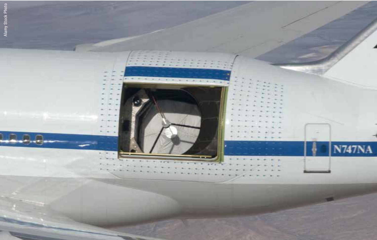
SOFIA (Stratospheric Observatory for Infrared Astronomy) в полете с открытой телескопной дверью. Самолет с телескопом поднимается на высоту 12—14 км и позволяет сделать качество получаемой «картинки» близкой на уровне космических обсерваторий
