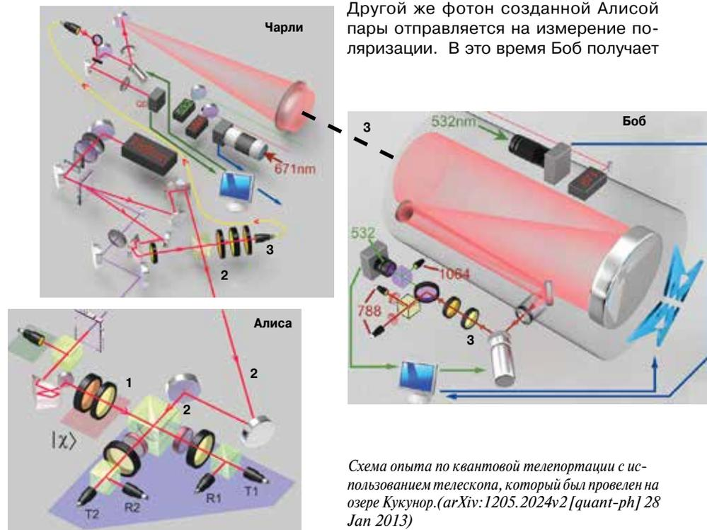
Схема опыта по квантовой телепортации с использованием телескопа, который был проведен на озере Кукунор. (arXiv:1205.2024v2 [quant-ph] 28 Jan 2013)
