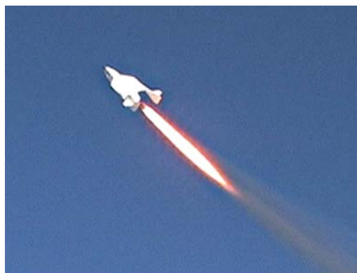
4 Полет ракетоплана «SpaceShipOne», оснащенного гибридным ракетным двигателем на закиси азота (окислитель) и бутадиеновом каучуке (твердое топливо)
