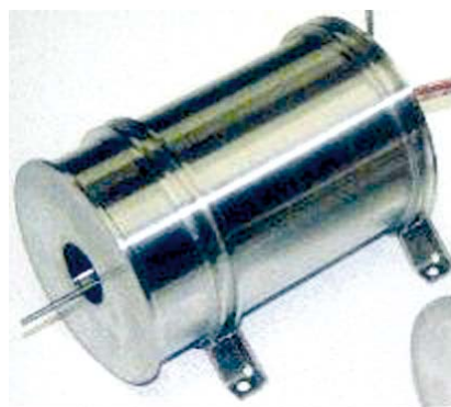
8 Электронагревный двигатель «Mark-IV». Тяга в вакууме 0,14 Н; удельный импульс 110 сек.
