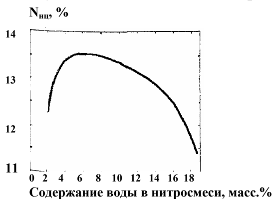
Рис. 2.1.1. Зависимость содержания азота в НЦ от содержания воды в нитросмеси (M=43, время нитрования 30 мин, температура 20°C, первоначальное количество \text{HNO}_3 в нитросмеси 25%)
