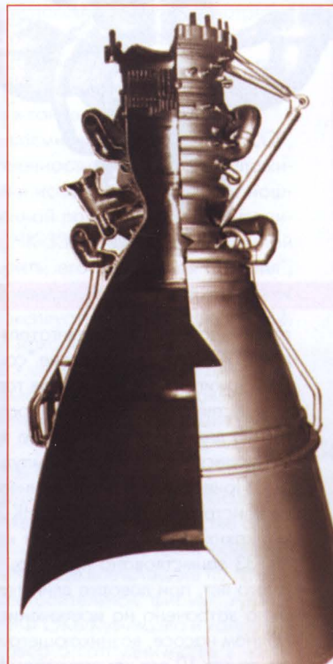
Паяно-сварная неразъёмная камера РД170 состоит из смесительной головки, камеры сгорания и сопла
