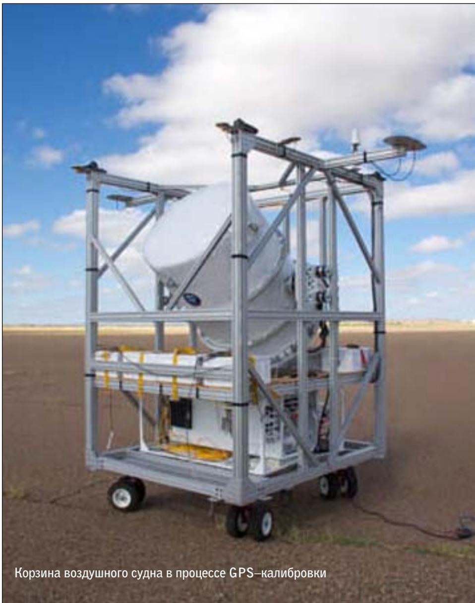
Корзина воздушного судна в процессе GPS-калибровки
