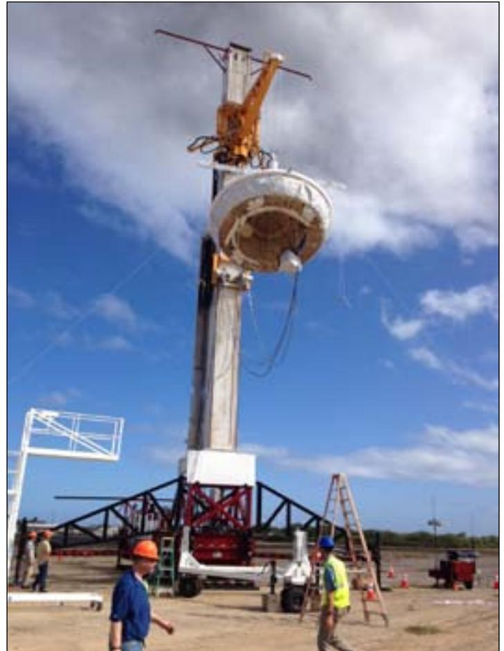
«Летающее блюдце» NASA – испытательная модель аппарата LDSD (Low Density Supersonic Decelerator /Сверхзвуковой замедлитель низкой плотности) - готово к первому запуску с пусковой площадки космодрома ВВС.
