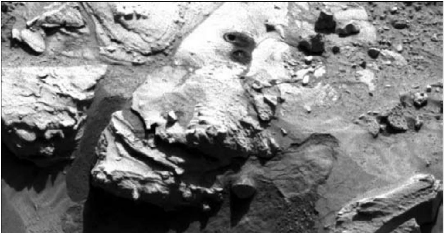
Curiosity провел бурильные работы на плите песчаника Windjana. Порода, измельченная в порошок бурильным молотком марсохода Curiosity, будет доставлена во бортовую лабораторию ровера для дальнейшего анализа.
